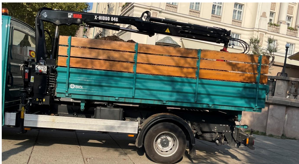
Slika 7. Utovarno – istovarna hidraulička dizalica na kamionu Zagrebačkog Holdinga
