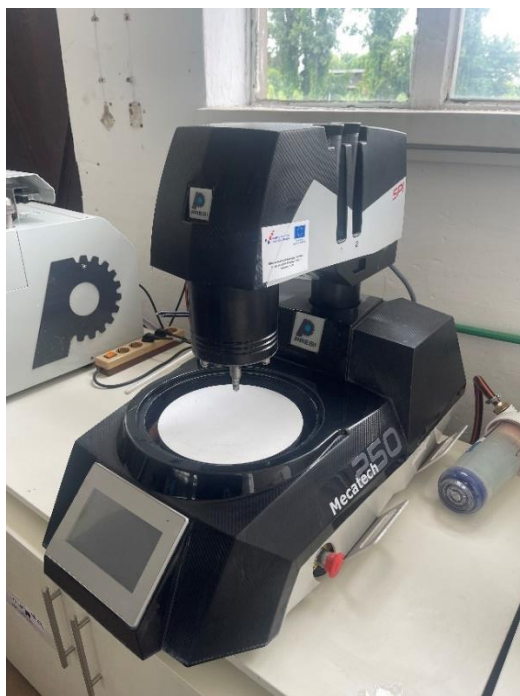
Slika 51. Uređaj za poliranje Mecatech 250
