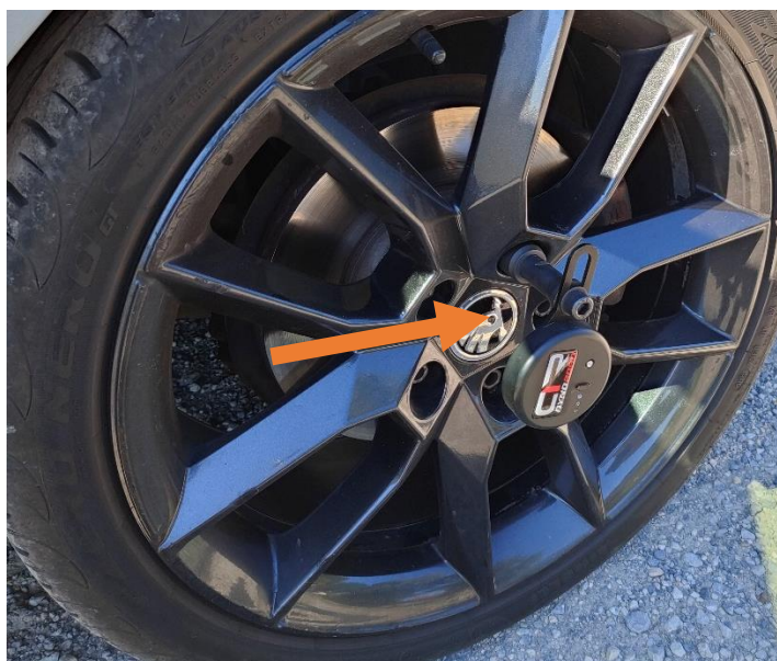
Slika 17. Prikaz montiranog DynoRoad uređaja
