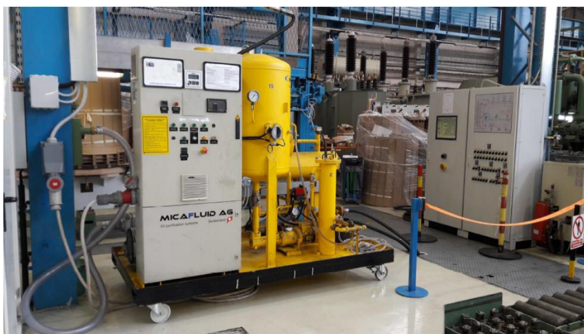
Slika 33. Uređaj za obradu ulja VOP030 Micafluid
