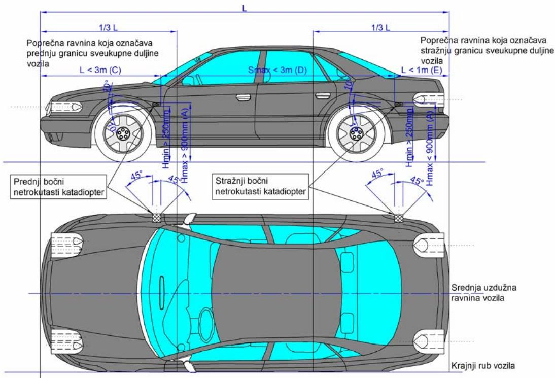
Slika 32. Položaj i geometrijska vidljivost bočnog netrokutastog katadioptera po ECEu.
