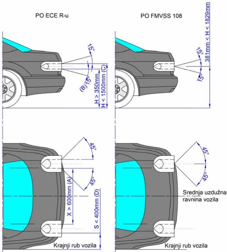
Slika 23. Usporedba položaja i geometrijske vidljivosti kočnog svjetla.
