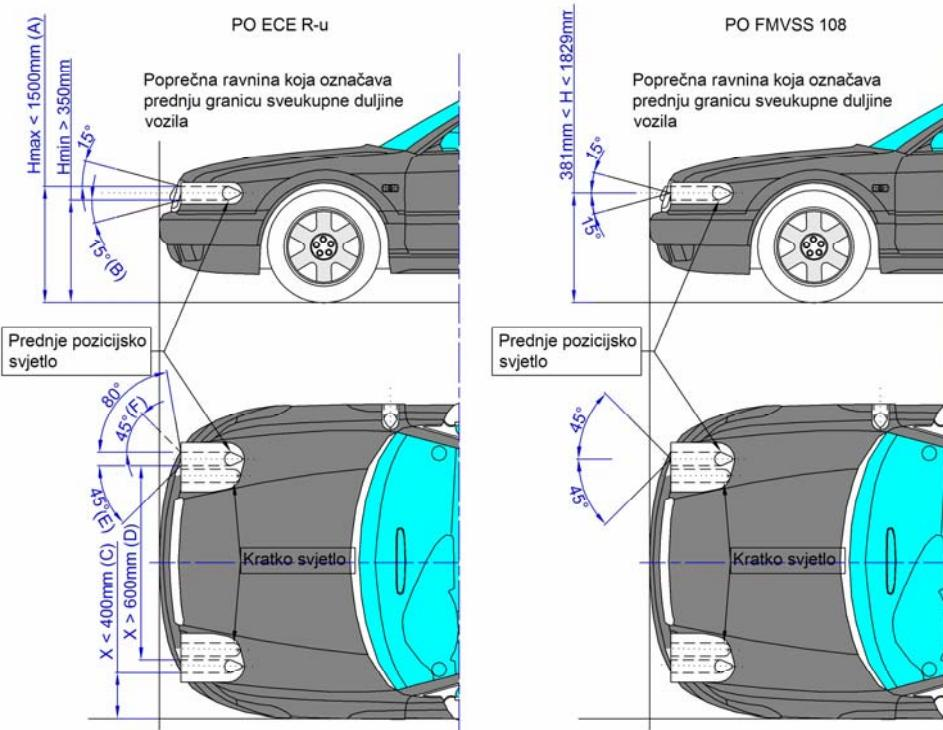
Slika 24. Usporedba položaja i geometrijske vidljivosti prednjeg pozicijskog svjetla.
