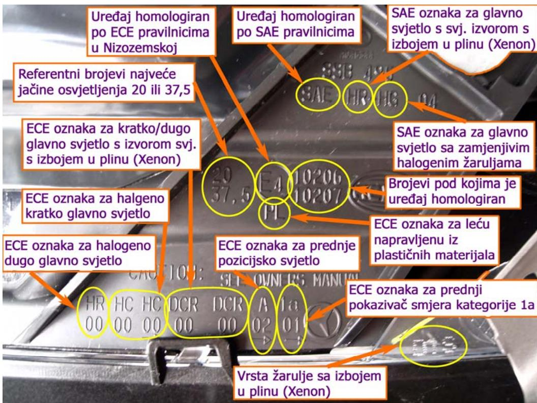
Slika 41. Oznake na glavnom svjetlosnom sklopu vozila Mercedes GL450 uvezanom iz EU
