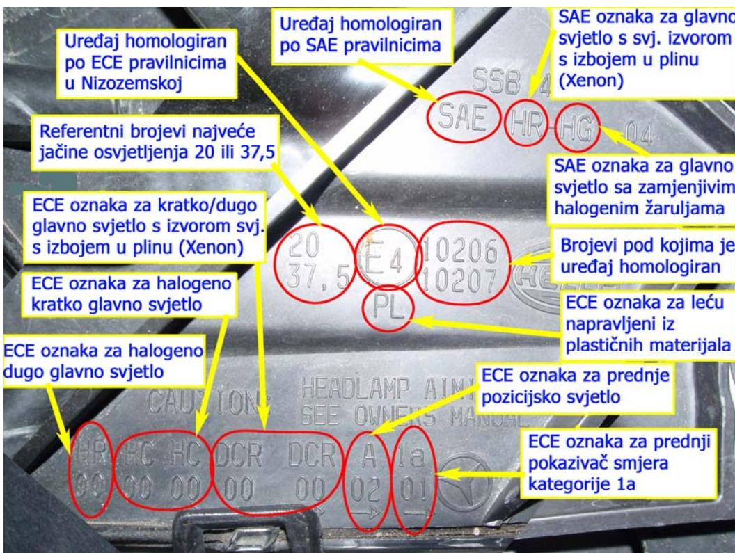
Slika 42. Oznake na glavnom svjetlosnom sklopu vozila Mercedes GL450 uvezanom iz SAD-a
