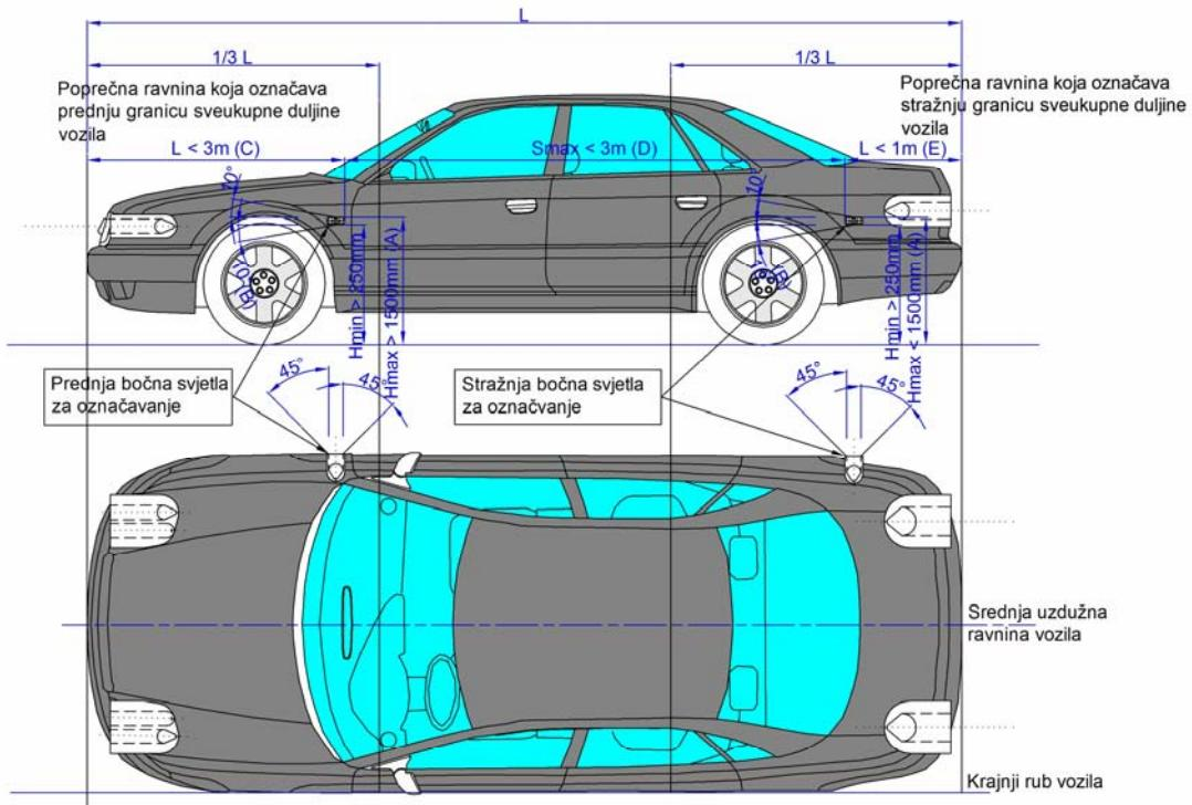
*Slika 33. Položaj i geometrijska vidljivost bočnih svjetala za označavanje po ECE R-u.*
