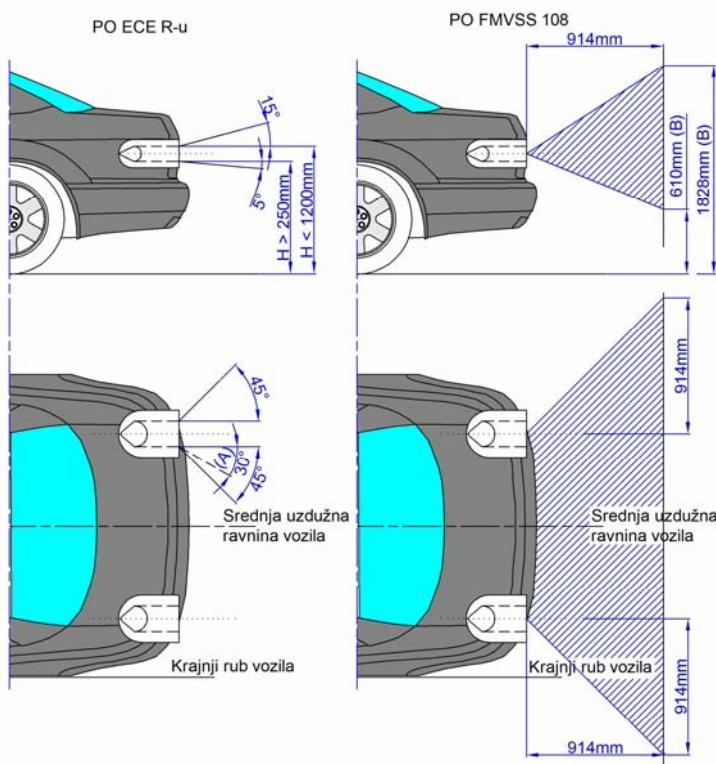
*Slika 19. Usporedba položaja i geometrijske vidljivosti svjetla za vožnju unatrag. Osjenčano područje označava područje vidljivosti. (A) Ako postoji dva svjetla za vožnju unatrag; (B) Udaljenost točke gledišta od razine zemlje*
