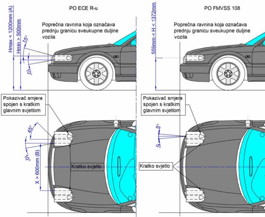
Slika 9. Položaj i geometrijska vidljivost kratkog glavnog svjetla.
