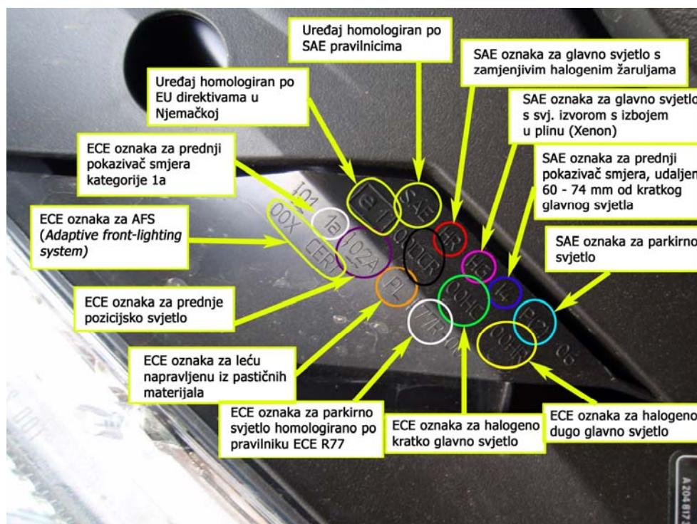
Slika 37. Oznake na glavnem svjetlosnom sklopu vozila Mercedes C300 uvezenom iz SAD-a
