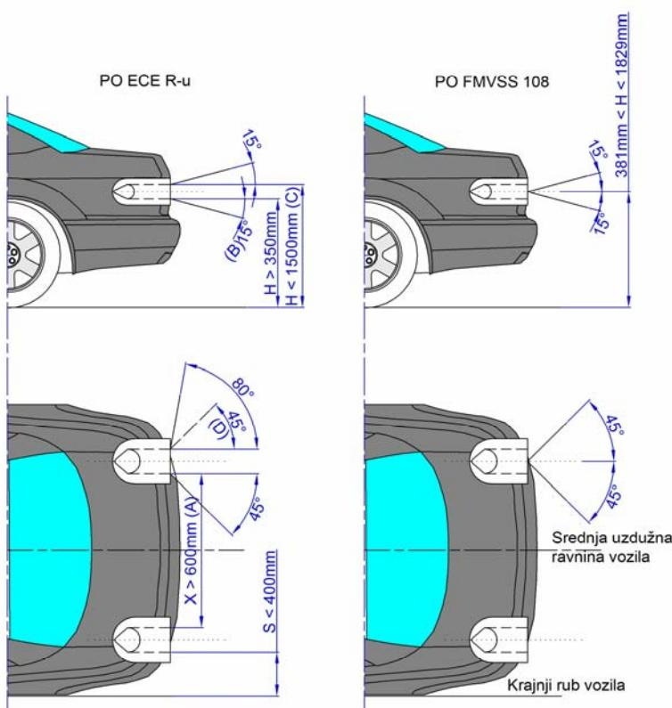
Slika 25. Usporedba položaja i geometrijske vidljivosti stražnjeg pozicijskog svjetla.
