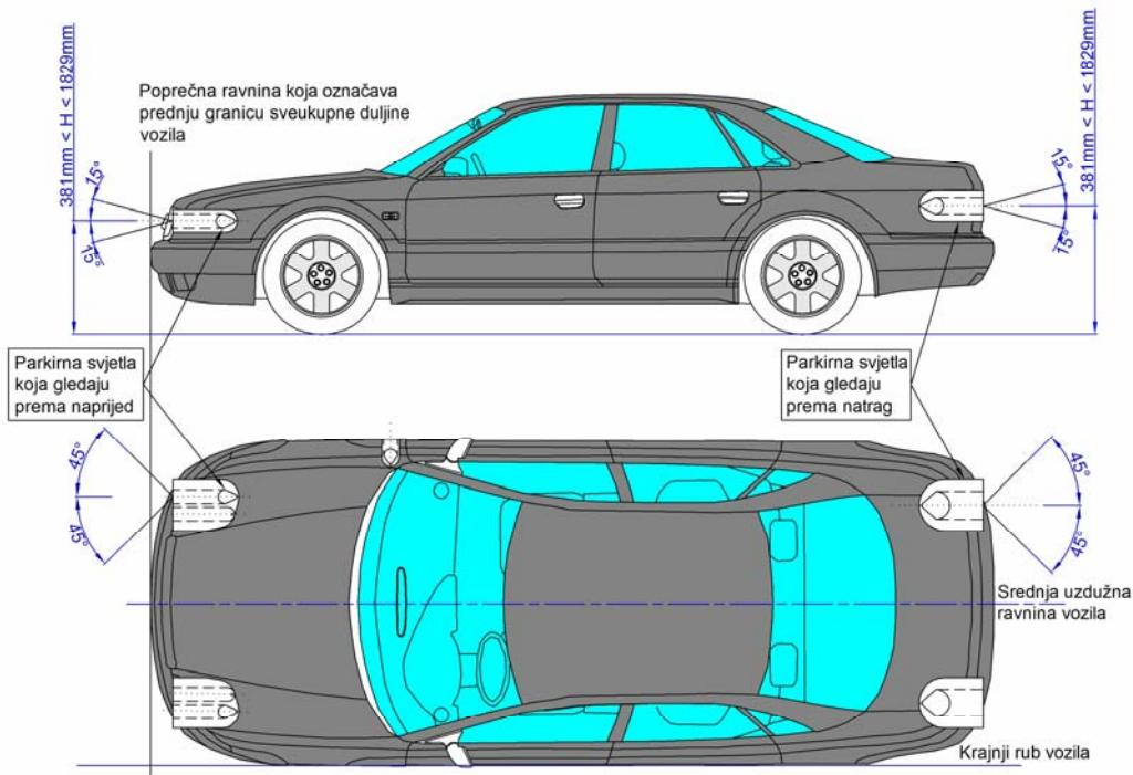
*Slika 28. Položaj i geometrijska vidljivost parkirnih svjetala po CFR-u.*
