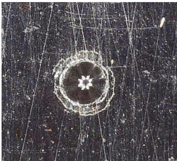
Slika 29. Otisak indentora na uzorku B3
