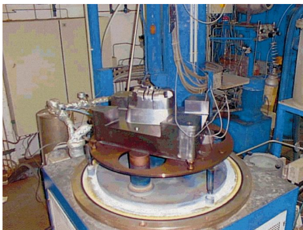
Slika 10. Polovica kalupa prevučena prevlakom TiCN-a [16]
