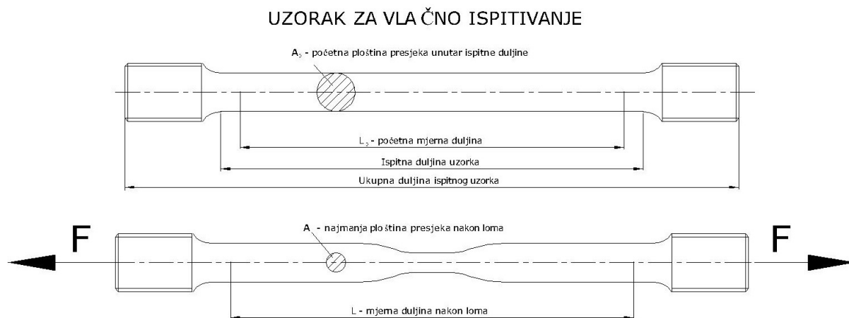
Slika 10: Rastezanje epruvete uz pomoć kidalice
