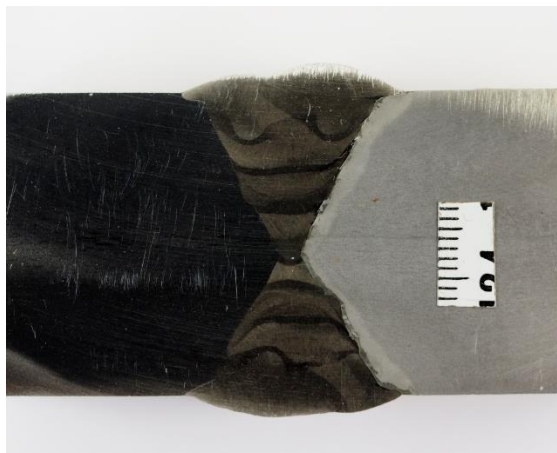
Slika 17. Makrostruktura zavarenog spoja od čelika X5CrNi18-10 i S355J2+N
