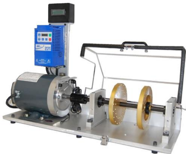
Slika 9. Simulator kvarova ležaja [7]
