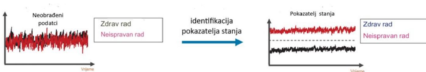
Slika 19. Korištenje pokazatelja stanja za detekciju kvarova [15]
