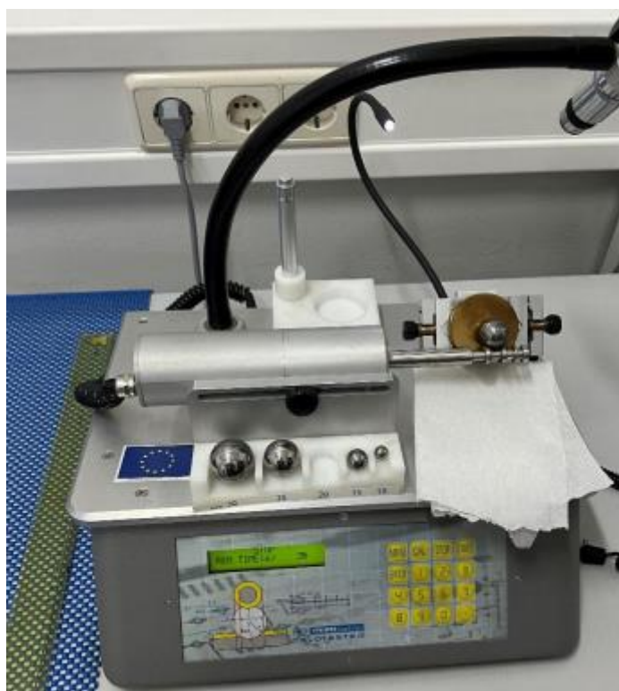
Slika 12. Calotester Tribotehnic na FSB-u u Zagrebu
