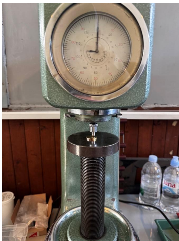
Slika 31. Utiskivanje Rockwell C indentora u uzorak prevučen prevlakom TiN PVD postupkom
