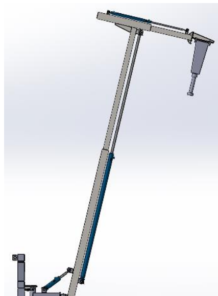
Slika 41. Položaj za izračun sile vertikalnog cilindra
