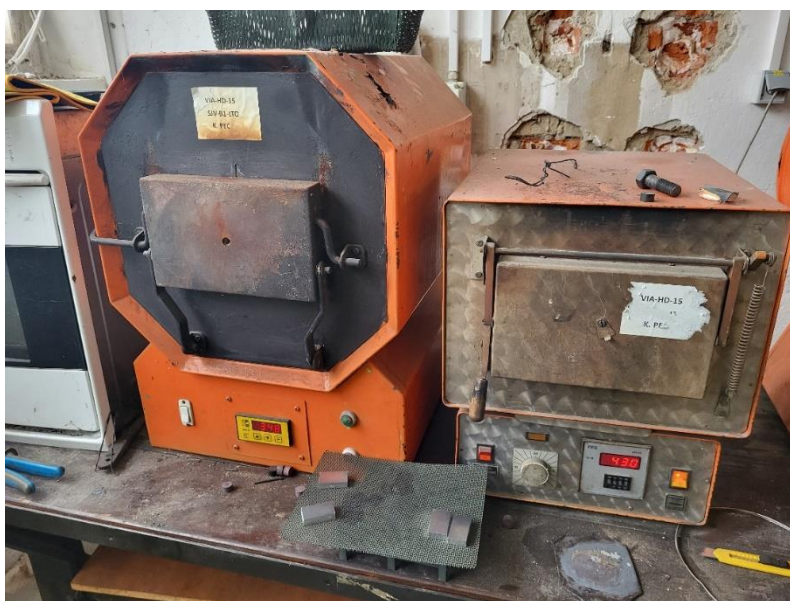
Slika 18 Žarenje uzoraka u pećima
