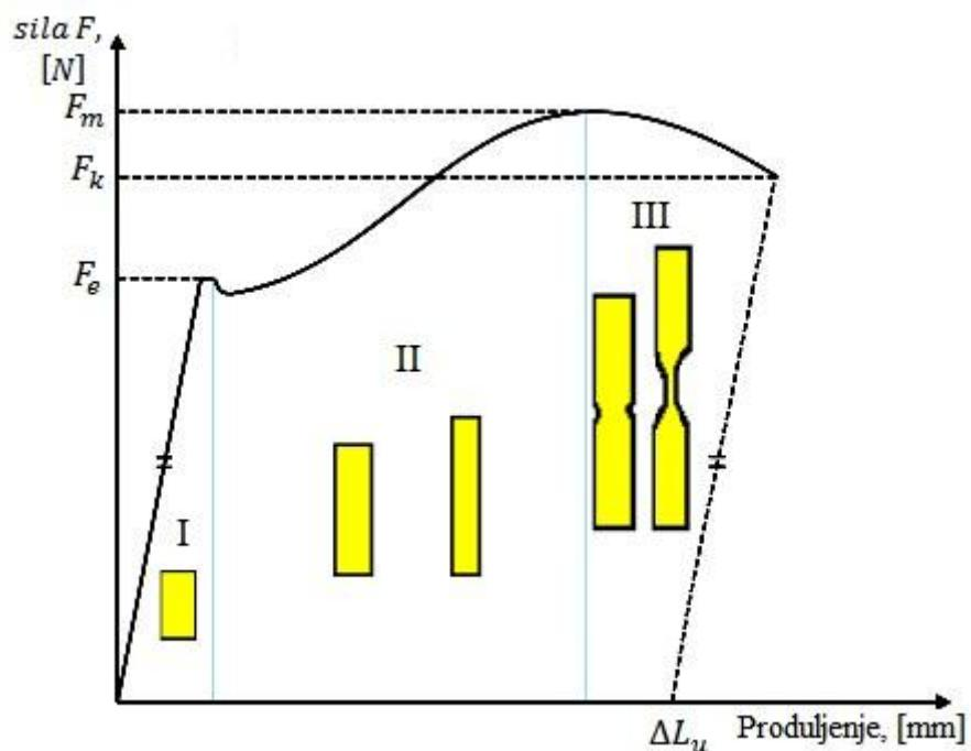
Slika 51. Dijagram sila - produljenje za konstrukcijski čelik
