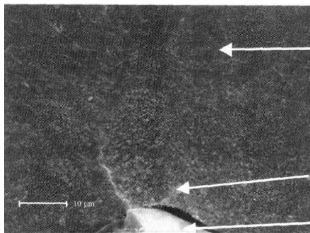
**Slika 20. Tvrda uključina kao izvor ispod površinskog začeća pukotine Cr-Mo čelika**
