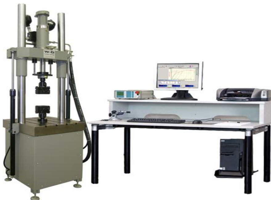
Slika 62. Servohidraulička umaralica LFV 50-HH s upravljačkom jedinicom
