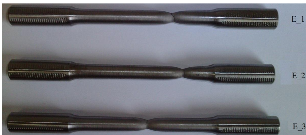
Slika 60. Epruvete nakon ispitivanja
