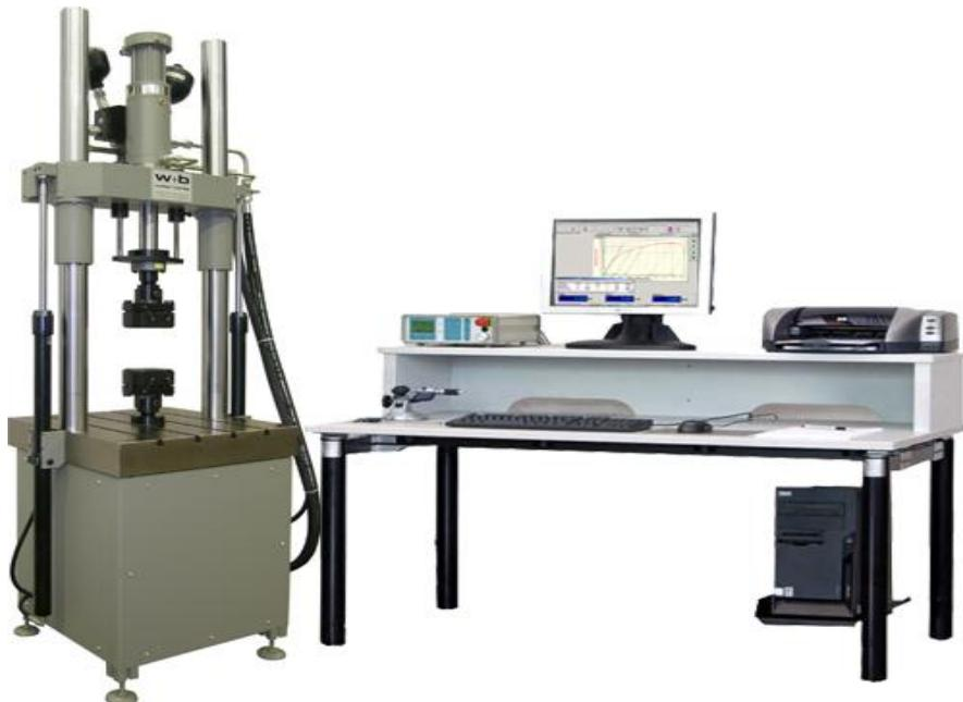
**Slika 62. Servohidraulička umaralica LFV 50-HH s upravljačkom jedinicom**
