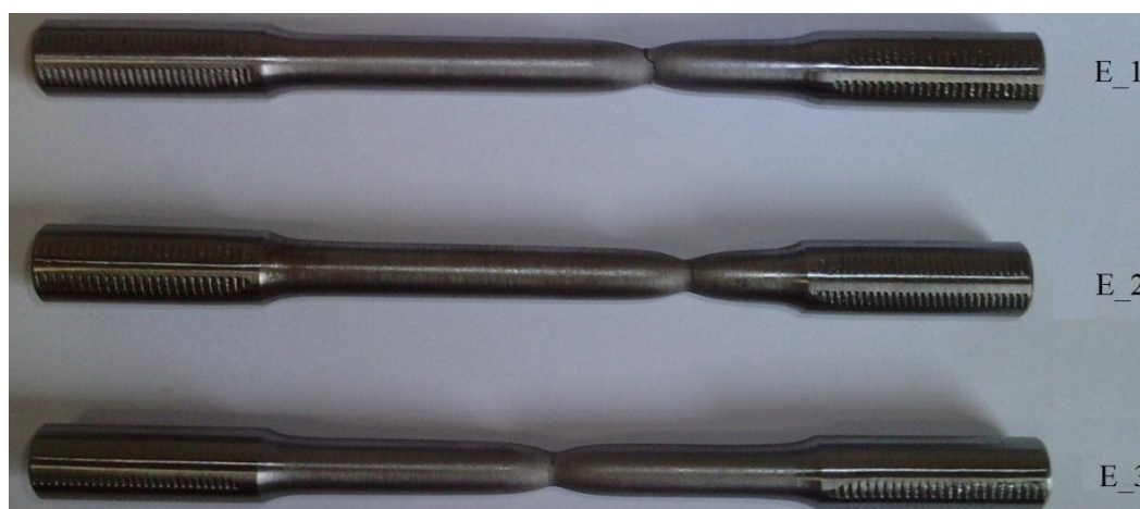
Slika 60. Epruvete nakon ispitivanja
