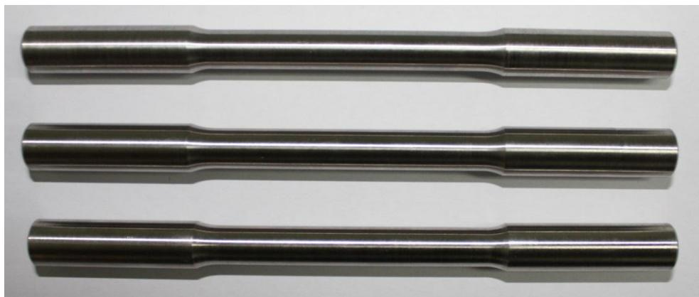
**Slika 55.** Epruvete korištene za provedbu eksperimenta
