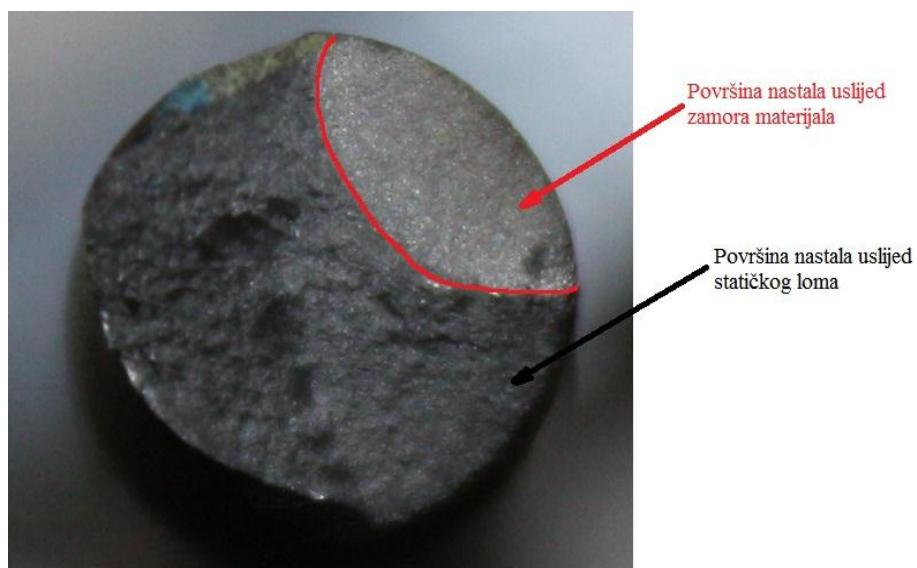
**Slika 64. Površina loma uslijed zamora epruvete E\_6**
