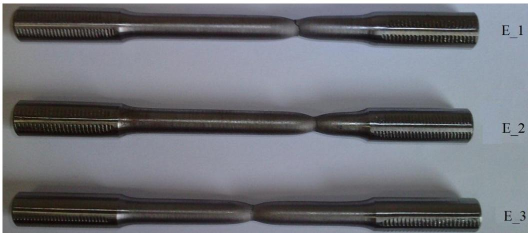
**Slika 60.** Epruvete nakon ispitivanja
