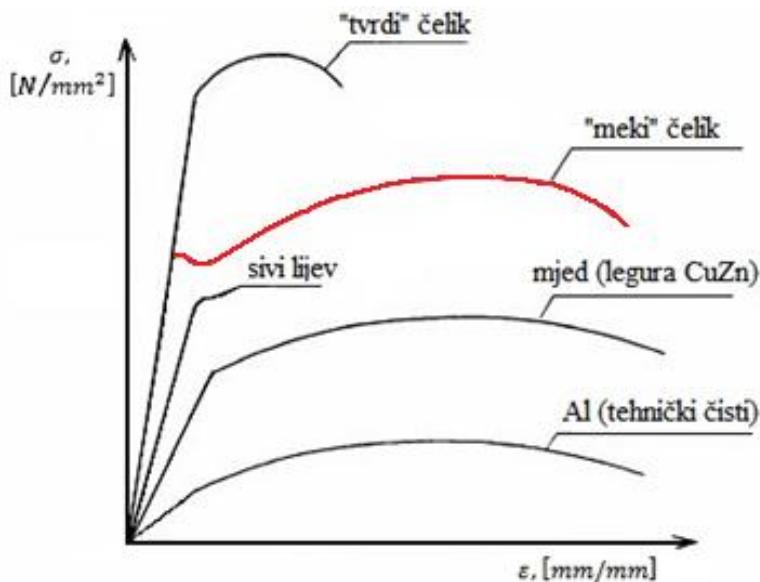
**Slika 53. Dijagram naprezanje - istezanje za neke metalne materijale [32]**
