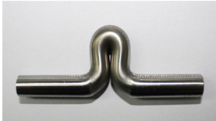
**Slika 65. Epruveta opterećena velikom tlačnom silom**
