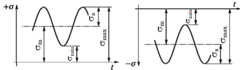
**Slika 32. Istopmjerno promjenjivo naprezanje s prednaprezanjem [10]**
