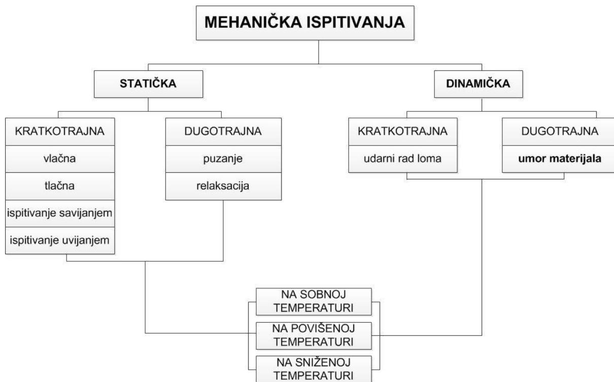
Slika 29. Sistematsizacija mehaničkih ispitivanja
