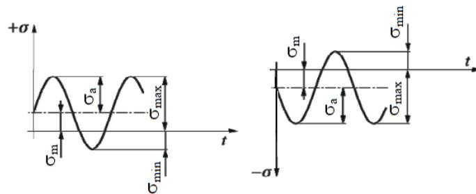
Slika 34. Naizmjenično promjenjivo naprezanje s prednaprezanjem [10]
