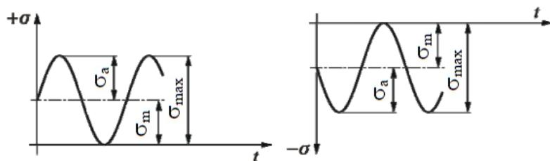
**Slika 33. Čisto istosmjerno promjenjivo naprezanje [10]**
