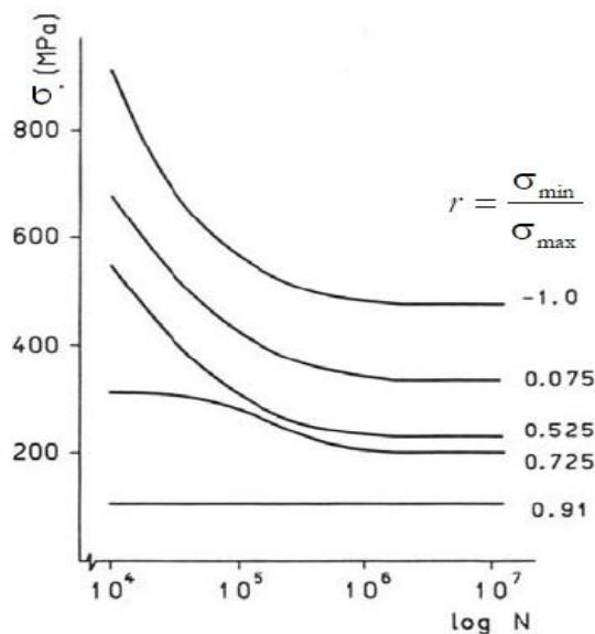
Slika 37. S-N krivulje kod promjene omjera naprezanja [11]
