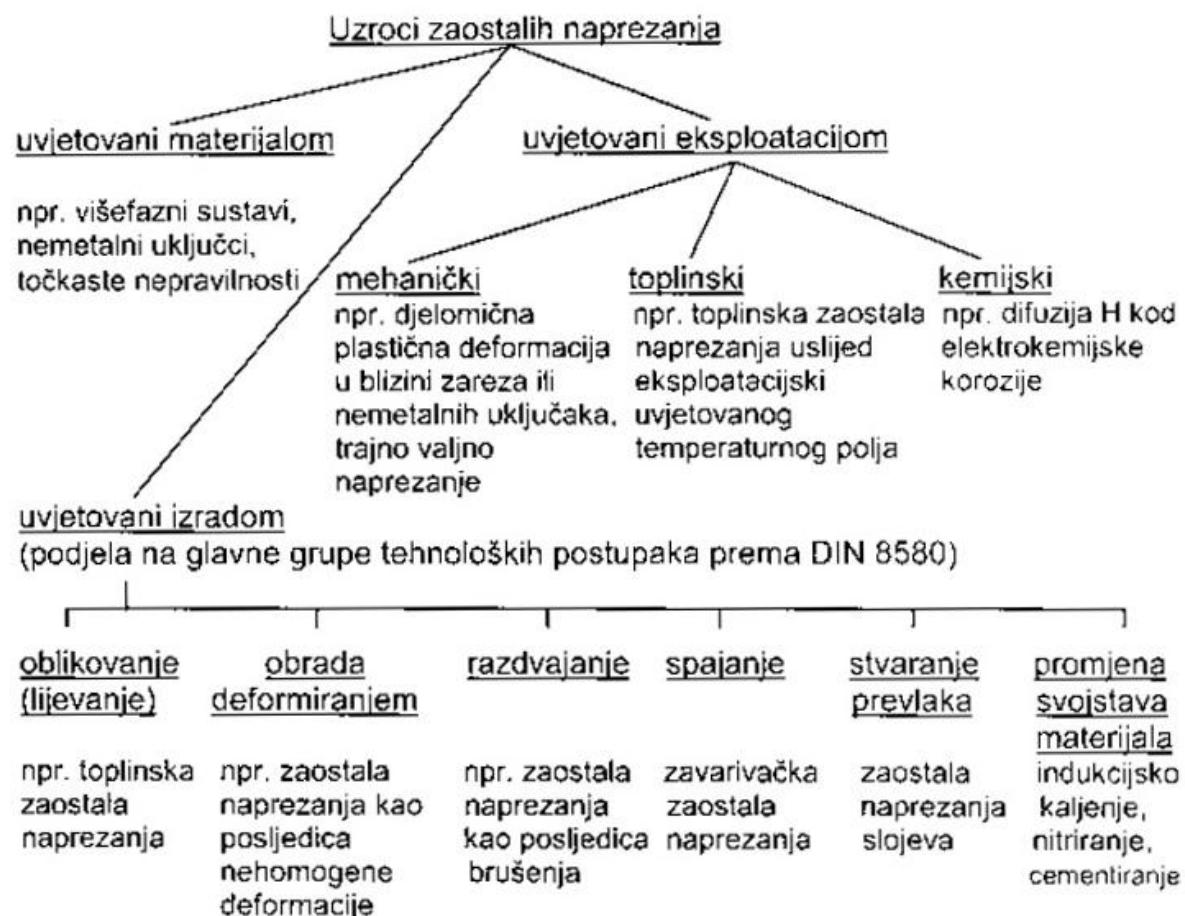
Slika 8. Shematski prikaz uzroka pojave zaostalih naprezanja [1]
