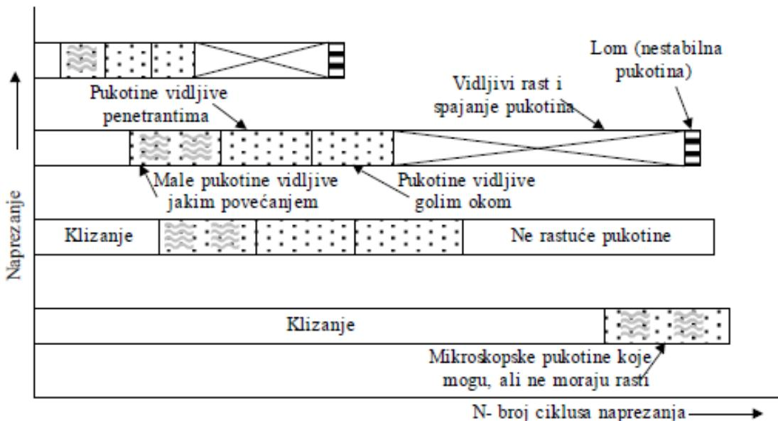
**Slika 25. Shematski prikaz procesa napredovanja zamornih pukotina [22]**
