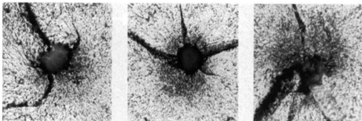
**Slika 21. Tri primjera trostrukog začeća mikropukotina na jednom izvoru kod Cr-Mo čelika [20]**
