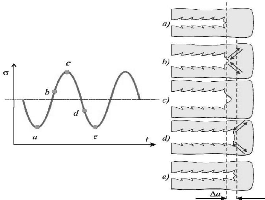
Slika 23. Produljenje pukotine u jednom ciklusu opterećenja [4]
