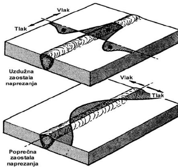
Slika 9. Raspodjela zaostalih naprezanja u zavarenom spoju [2]
