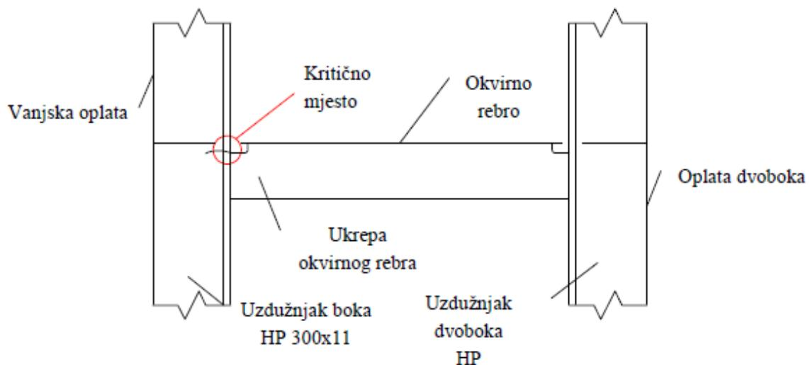
Slika 13. Zamorno oštećenje uzdužnjaka tankera - bok broda [5]
