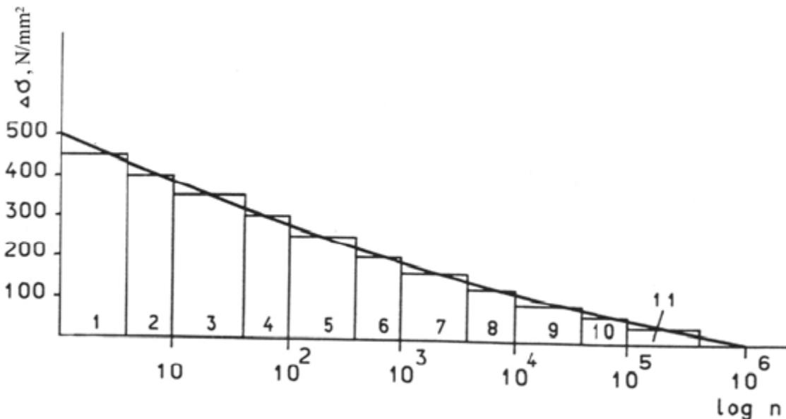
Slika 43. Razdioba naprezanja podijeljena u blokove konstantnog naprezanja [2]
