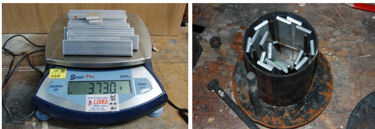
Slika 52 – Postupak određivanja količine (mase) prekursora i punjenja kalupa
