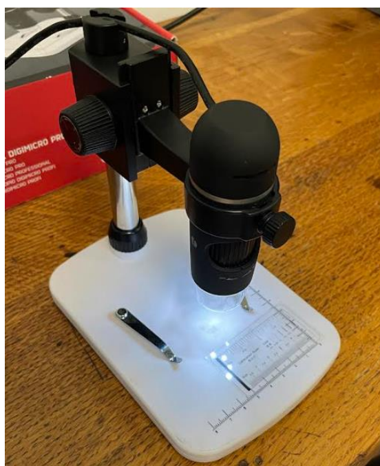
Slika 34. Kalibracija kamere prije korištenja
