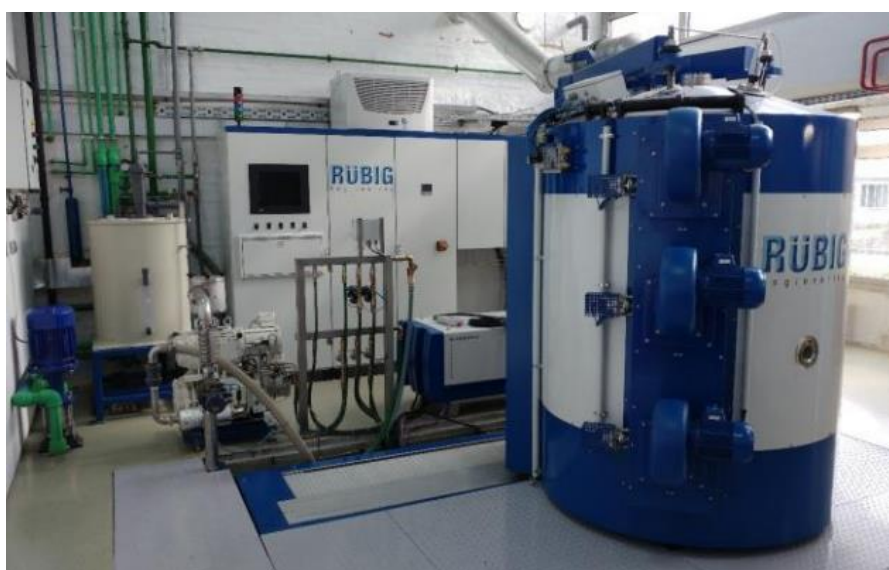
Slika 20. Peć za nitriranje u plazmi Rubig PN 70/90
