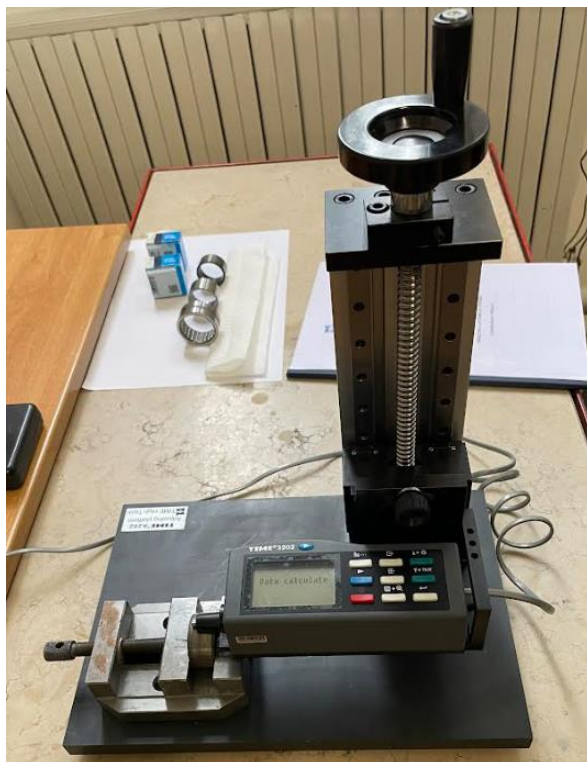
Slika 25. Postav za mjerenje hrapavosti
