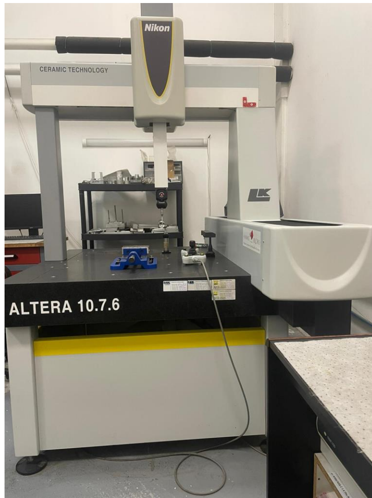
Slika 86. Trokoordinatni mjerni uređaj
