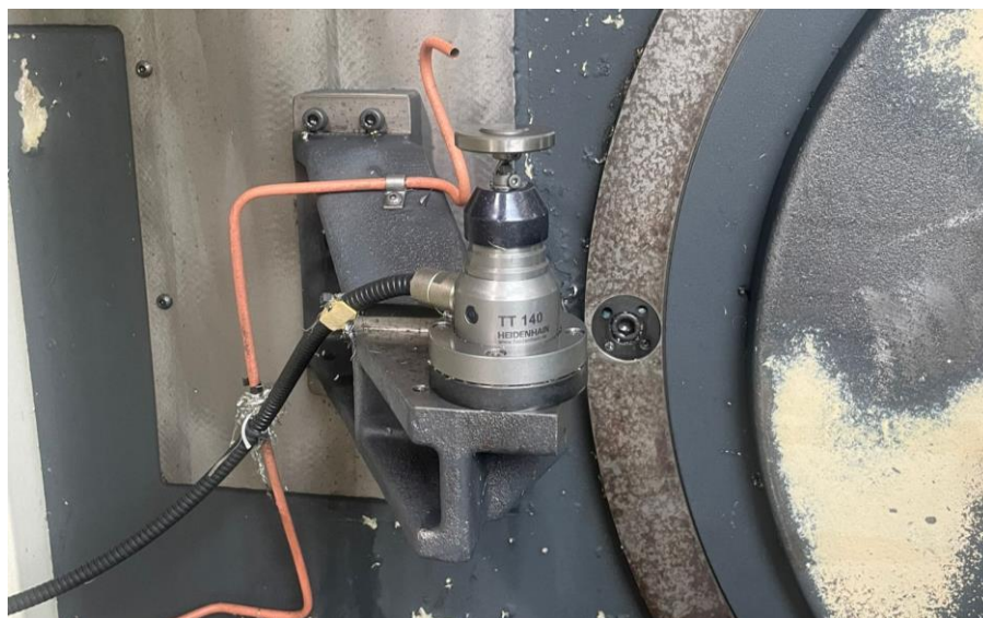
Slika 66. Mjerni uređaj za određivanje ispona i promjera alata
