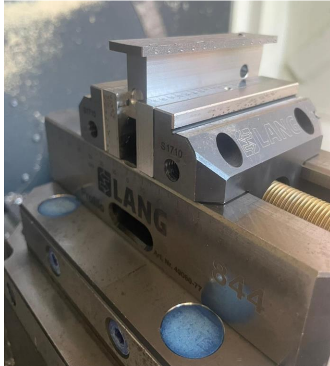
Slika 71. Škripac i obradak u drugome stezanju
