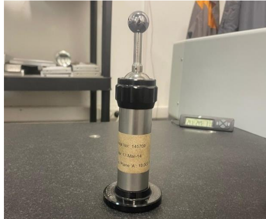
Slika 87. Kontrolnik za umjeravanje ticala
