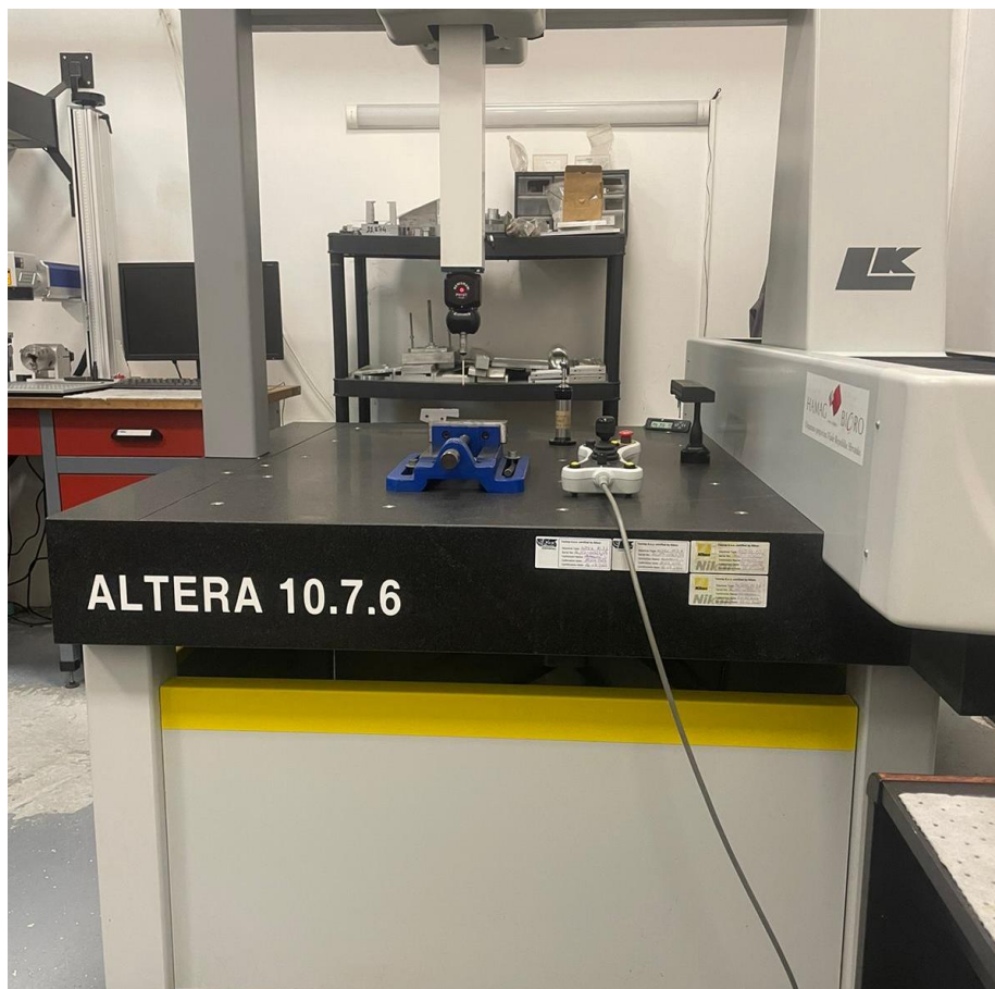
Slika 90. Položaj obratka pri mjerenju na trokoordinatnom mjernom uređaju
