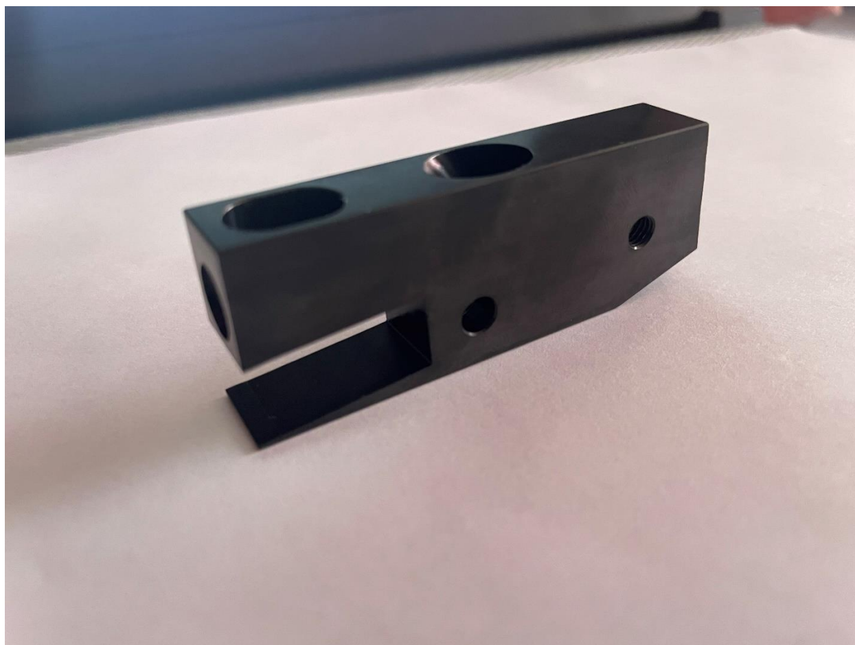
Slika 96. Obradak nakon bruniranja
