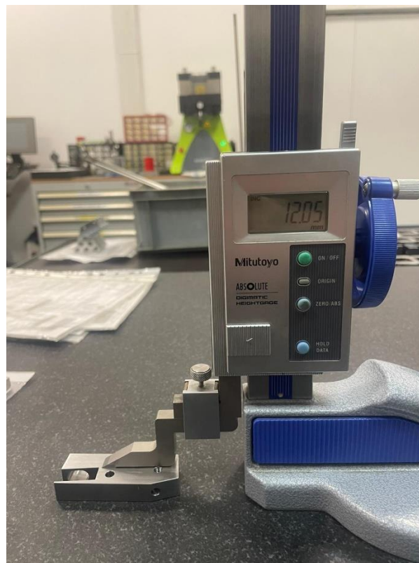
Slika 80. Mjerenje širine obratka
