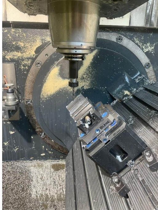
Slika 70. Bušenje svrdlom 4,3 mm u rotaciji
