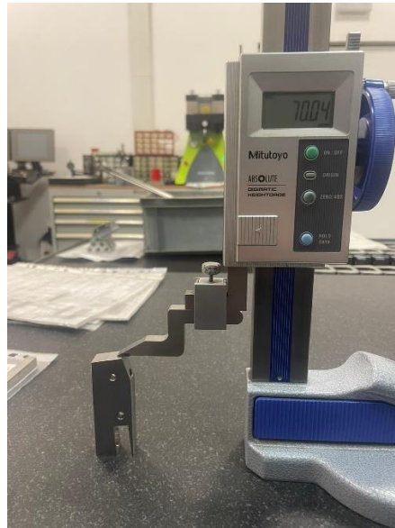
Slika 79. Mjerenje duljine obratka
