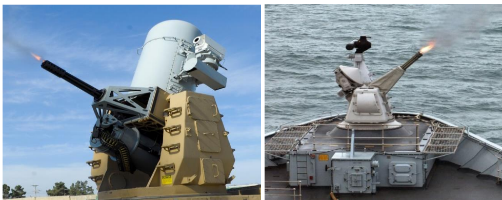
Slika 1 Kupola obrambenog sustava Phalanx (lijevo) i Goalkeeper (desno)
