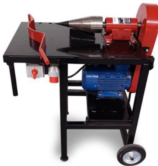
Slika 3. Cjepač drva s konusom
