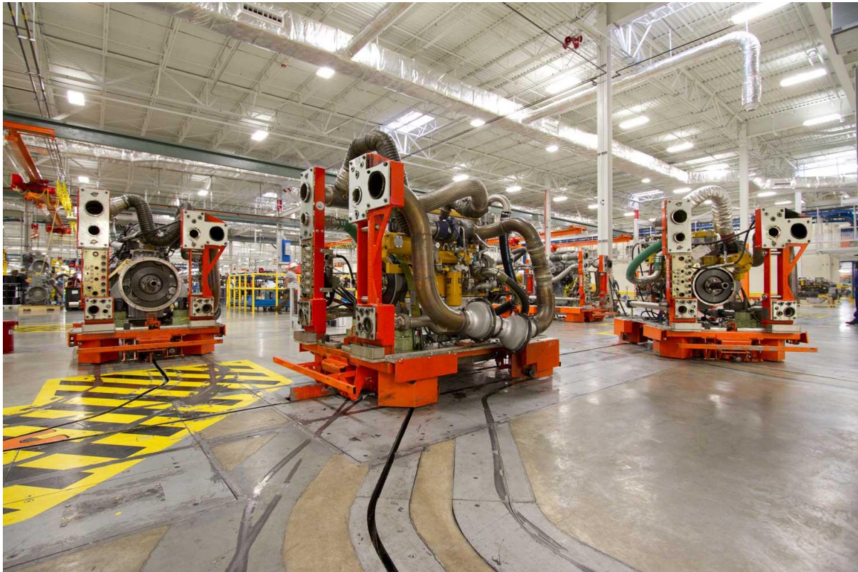
Slika 2.4 Paletni sustav za serijsko testiranje motora [4]
