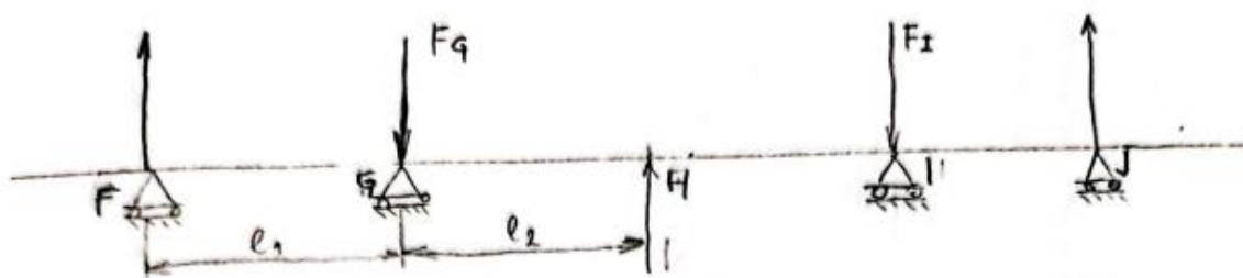
Slika 14 Osovina zgloba B s ucrtanim opterećenjem
