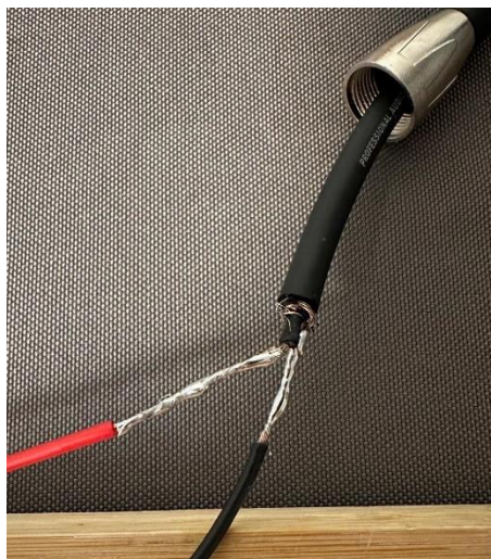
Slika 39. Spoj vodiča i mikrofonskog kabla
