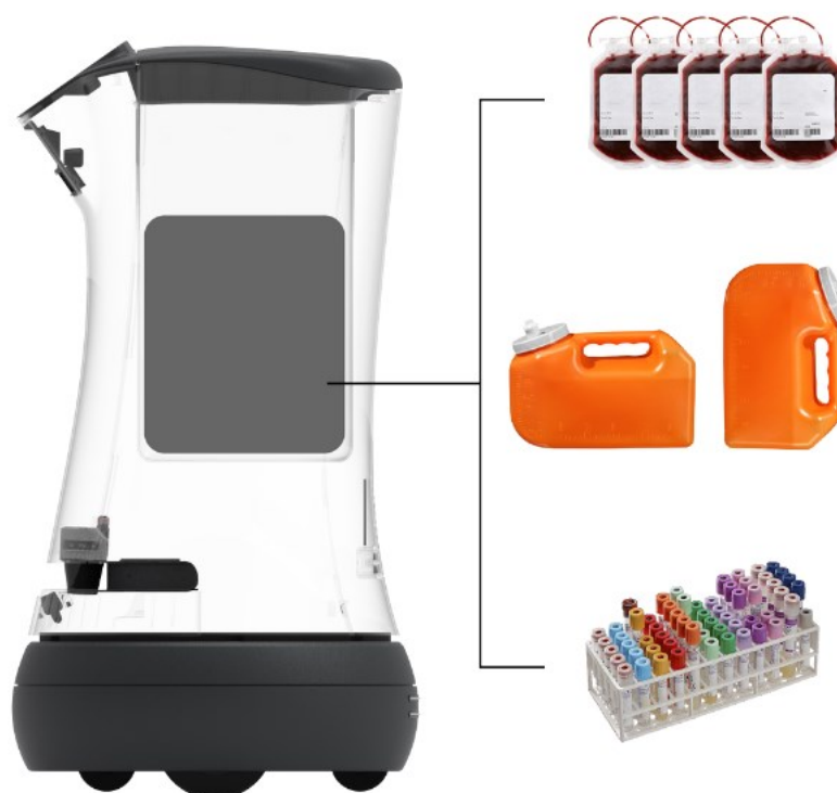
Slika 8. Robot Relay s primjerima korisnog tereta [12]
