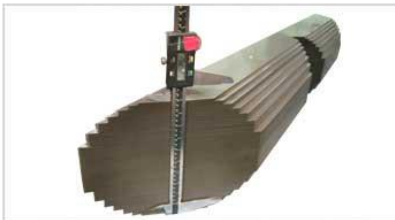
Slika 28. Pozicija jezgre transformatora
