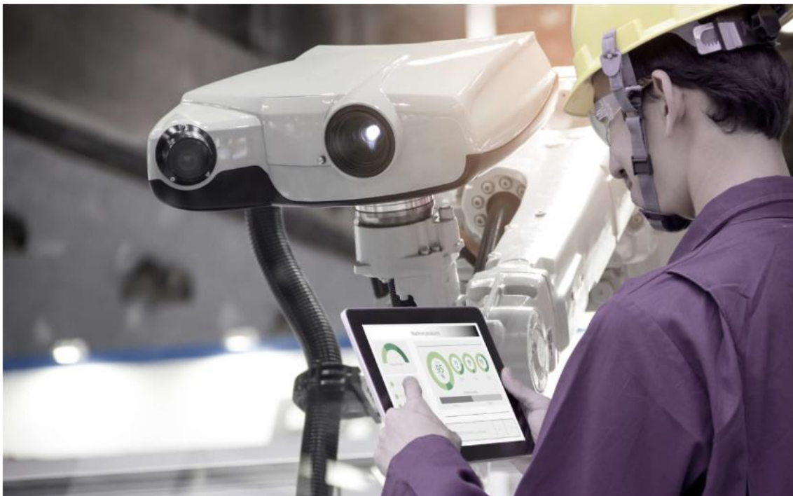
Slika 10. Visokorezolucijske kamere koje prikupljaju vizualne podatke za obradu u kontroli kvalitete [14].
