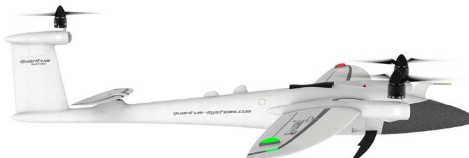
Slika 2.11. Trinity F90+ u poziciji za vertikalni let [10]
