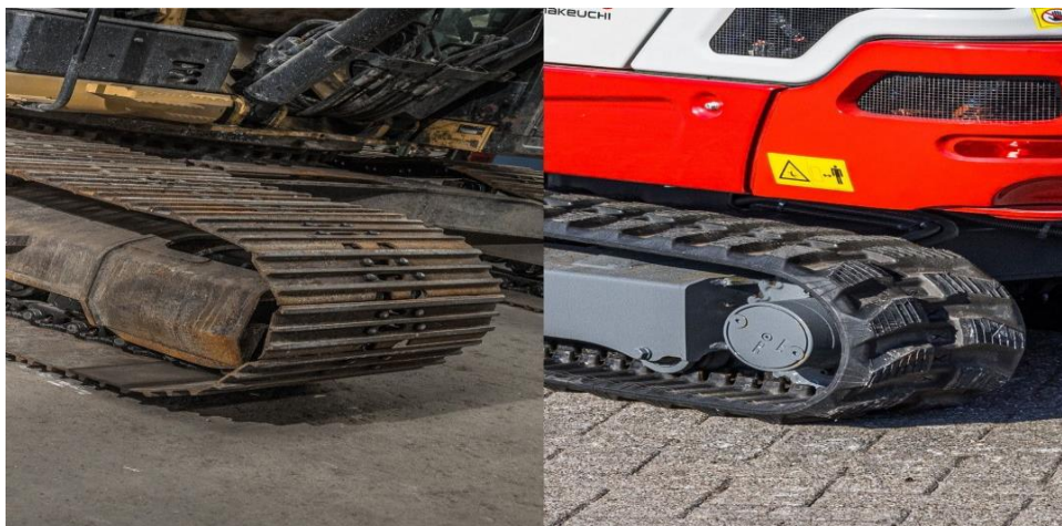
Slika 17. Prikaz čeličnih (lijevo) i elastomernih (desno) gusjenica [32]
