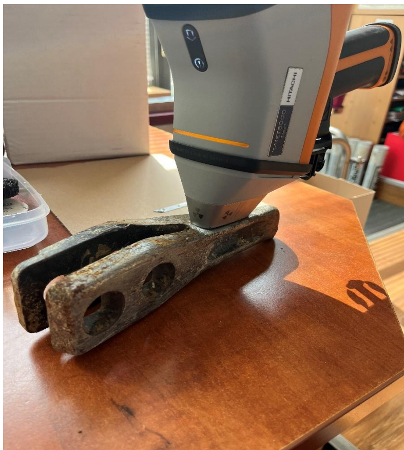
Slika 28. Tijek ispitivanja uzorka 1 XRF metodom
