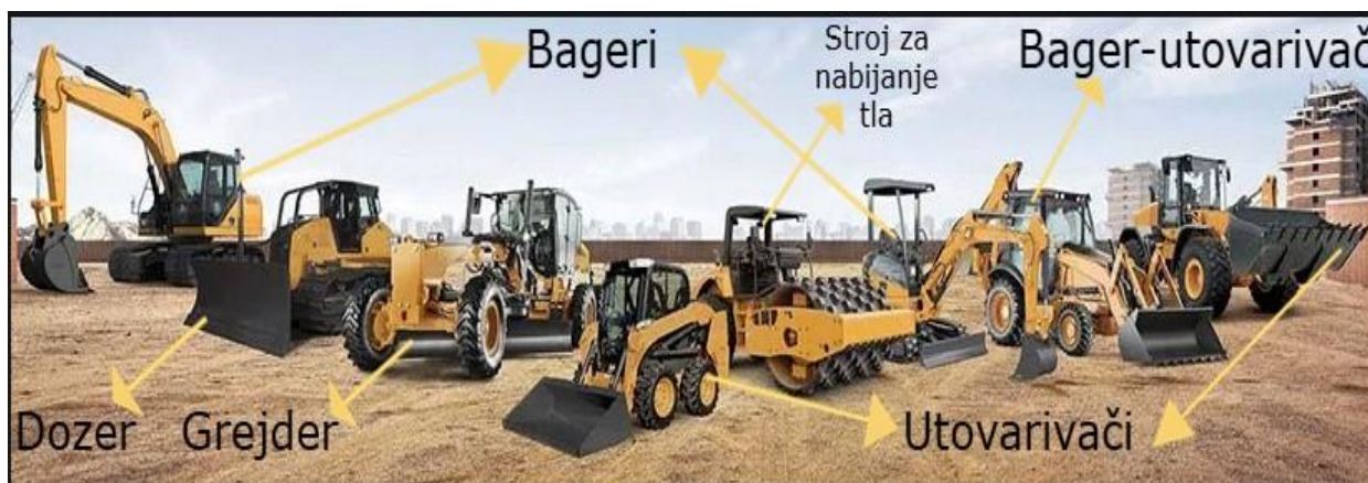
Slika 1. Osnovne vrste građevinskih strojeva [6]
