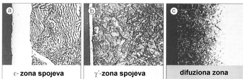
Slika 9. Mikrostruktura površinskog sloja nitriranog čelika [10]
