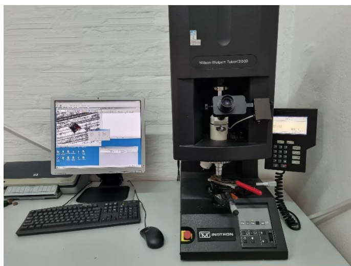
Slika 31. Tvrdomjer Wilson-Wolpert Tukon 2100B
