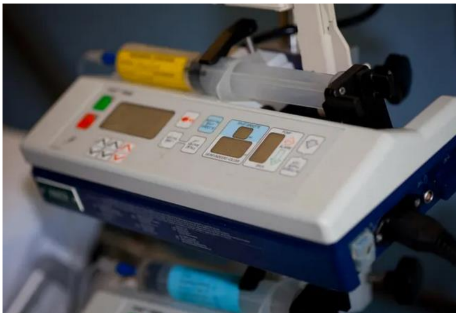
Slika 32: Kućište medicinskog uređaja izrađeno od PC/PET mješavine [34]
