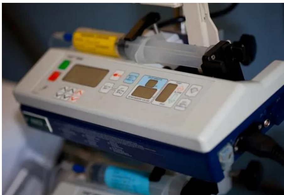
Slika 32: Kućište medicinskog uređaja izrađeno od PC/PET mješavine [34]
