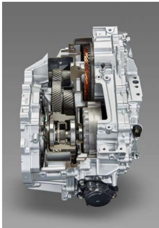
Slika 7 Elektronički kontrolirani varijabilni prijenos (e-CVT)
