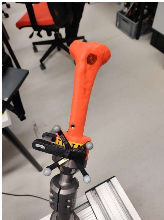
Slika 38. 3D printana kost tibije sa statičnim markerom
