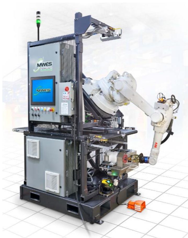
Slika 35. Sustav za automatsku izmjenu obratka [39]
