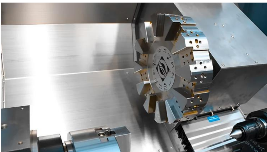
Slika 24. Revolverska glava bez postavljenih alata [28]
