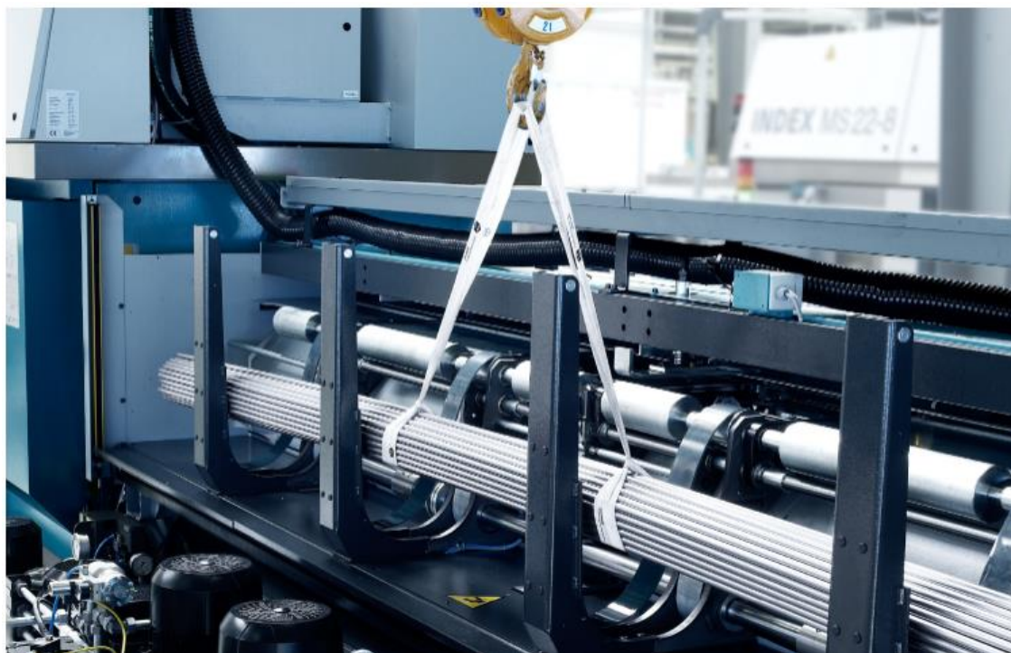
Slika 34. Spremnik za šipke u dodavaču [35]
