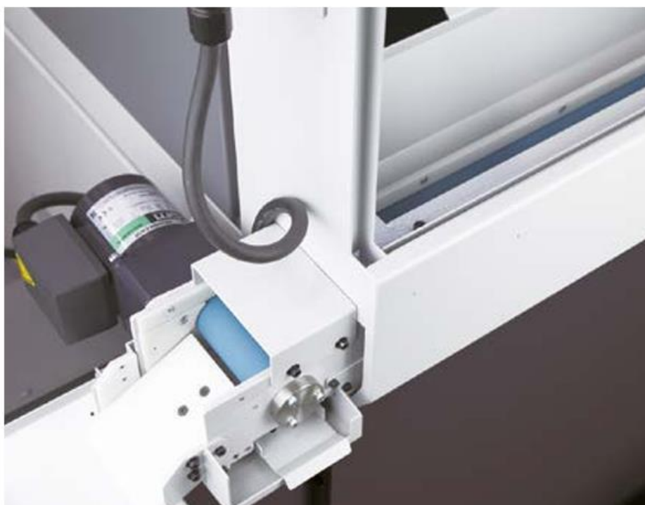
Slika 46. Konvejer za transport izradaka pogonjen elektromotorom [46]
