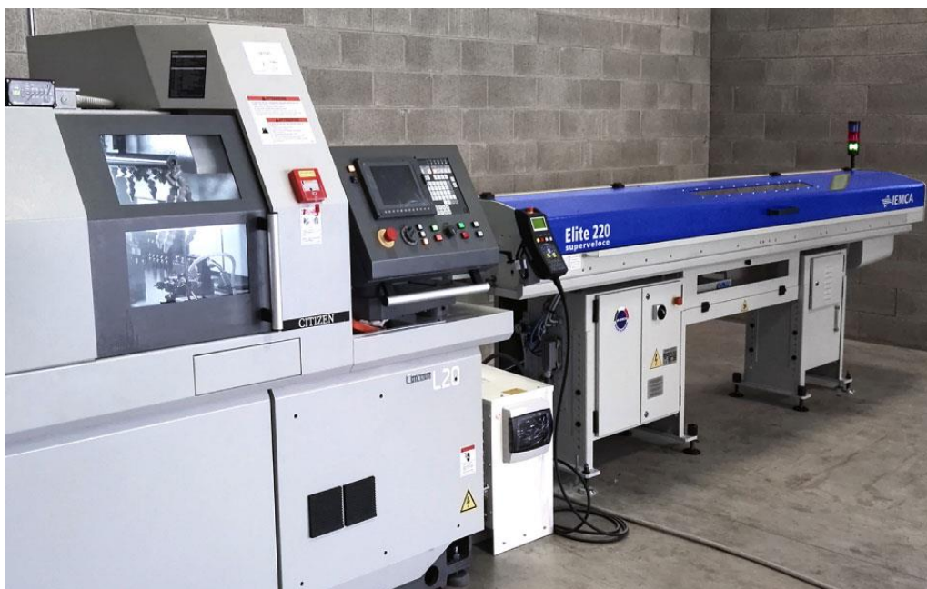
Slika 45. Swiss-type tokarilica s dodavačem šipke [47]
