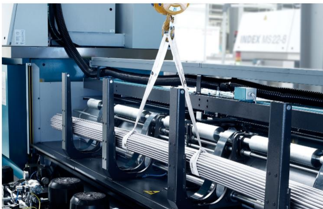
Slika 34. Spremnik za šipke u dodavaču [35]
