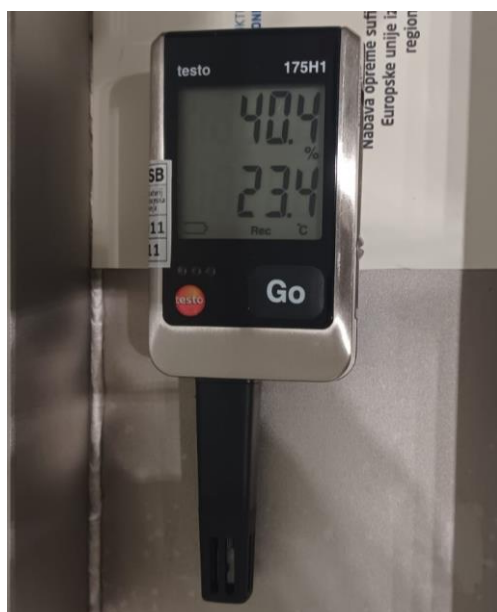
Slika 12. Uređaj Testo 175H1 za mjerenje temperature i vlažnosti zraka
