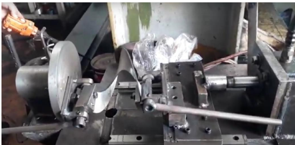
Slika 5. Razvlačenje lima pomoću hidrauličkog pogona
