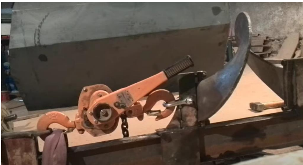
Slika 4. Razvlačenje lima pomoću ručnog pogona
