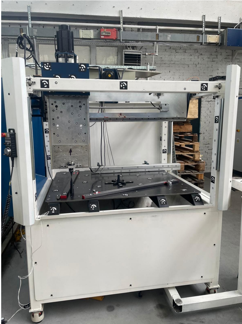
Slika 3.1 Numerički upravljani alatni stroj ADRISS
