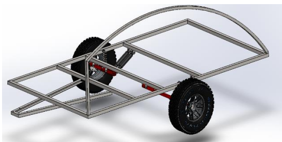
Slika 74. Zavareni luk i vertikalni nosač
