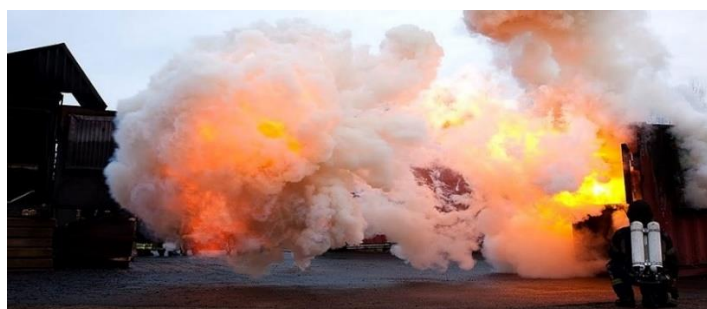
Slika 3 Pojava plamenog jezika prilikom ulaska u eksplozivnu atmosferu [6]
