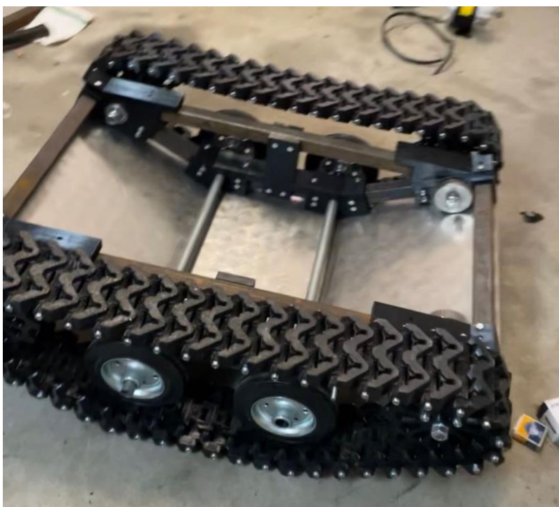
Slika 19 Izrada i spajanje pogonskog sklopa
