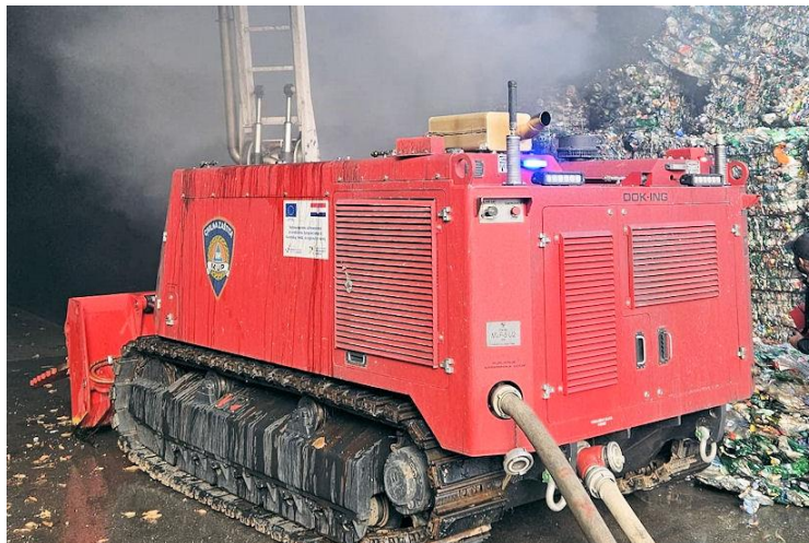
Slika 2 Mobilni robot MVF-5 tvrtke DOK-ING u vlasništvu Civilne zaštite RH [5]
