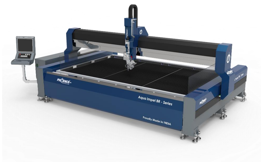
Slika 8. 5-osni stroj za rezanje vodenim mlazom [14]
