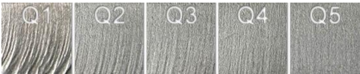
Slika 5. Rangiranje kvalitete površine rezanih rubova vodenim mlazom [10]
