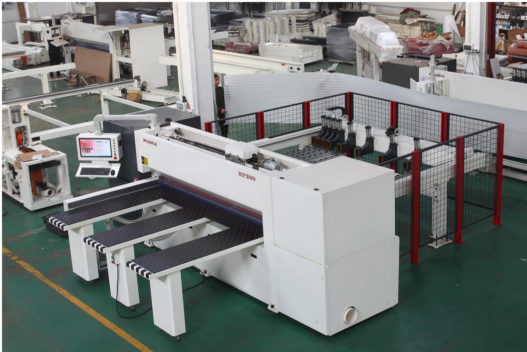
Slika 23. CNC pila za panele [42]
