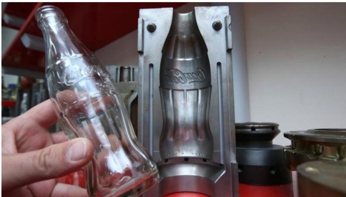
Slika 2. Primjer kalupa iz tvrtke OMCO [4]
