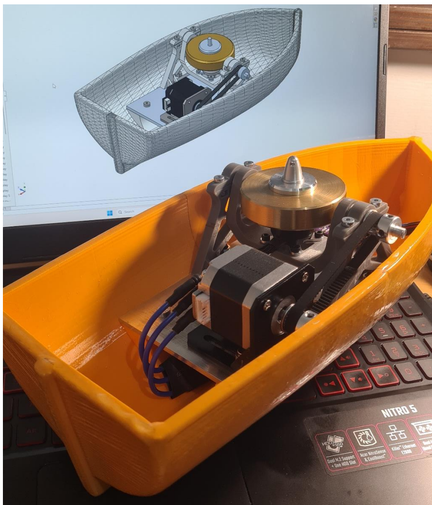
Slika 38. Sastavljeni model giroskopskog stabilizatora u maketi broda
