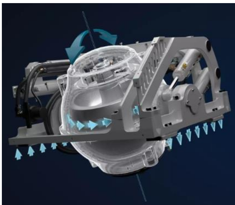
Slika 4. Primjer giroskopskog stabilizatora marke Seakeeper [5]
