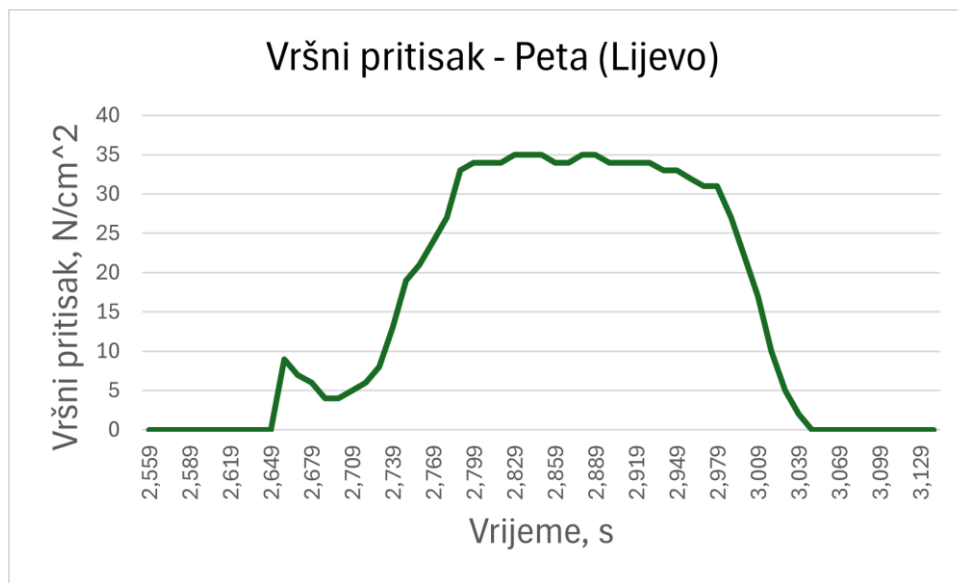
Slika 33. Dijagram vrijednosti pritiska u ovisnosti o vremenu pri iskoraku kod penjanja uz stepenice (peta lijeve noge)
