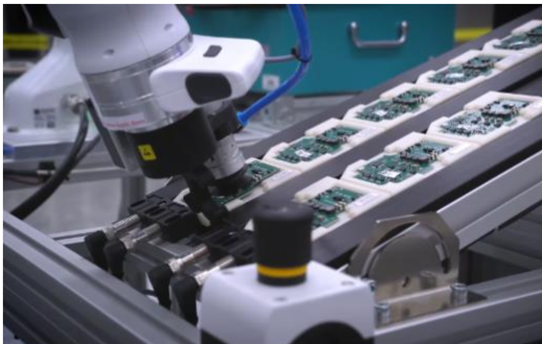
Slika 4. Kobot UR3 provodi kontrolu kvalitete [9]
