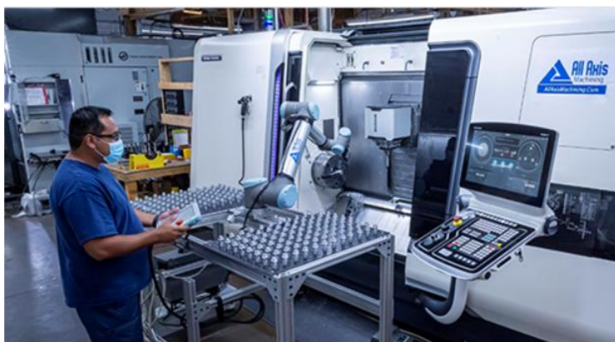
Slika 3. Kobot u izvršavanju operacije opsluživanja stroja [8]
