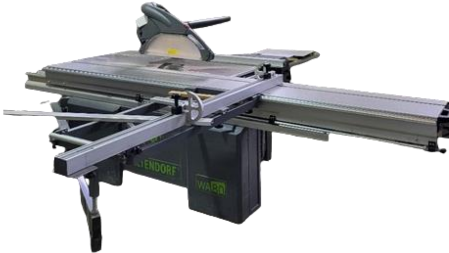
Slika 1. Stolna klizna pila Altendorf WA80
