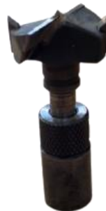
Slika 13. Svrldo za izradu okova \varnothing 35 \times 55 mm
