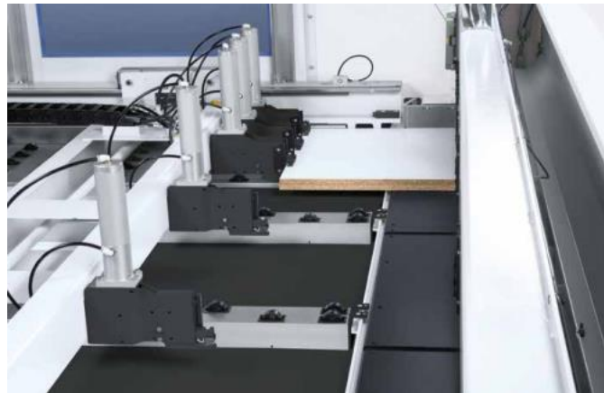
Slika 17. Programaska ograda za preciznost i dimenzijsku točnost [10]
