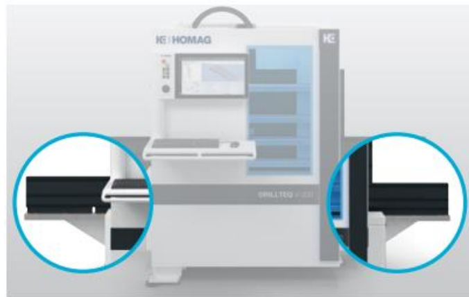
Slika 31. Mehanička potpora pomoću valjkastog transportera prilikom stavljanja i uklanjanja radnog materijala [12]
