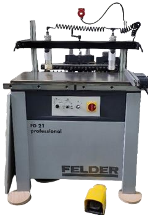
Slika 5. Viševretna bušilica Felder FD21 professional
