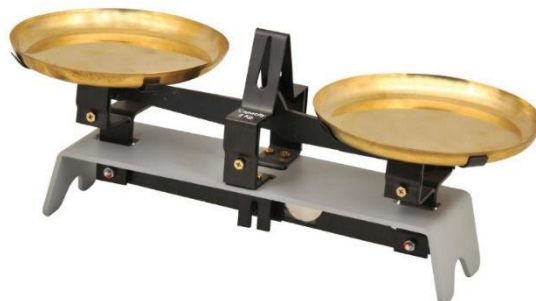
Slika 18. Komercijalna vaga na bazi Robervalovog principa
