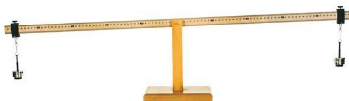
Slika 20. Jednostavni polužni mehanizam
