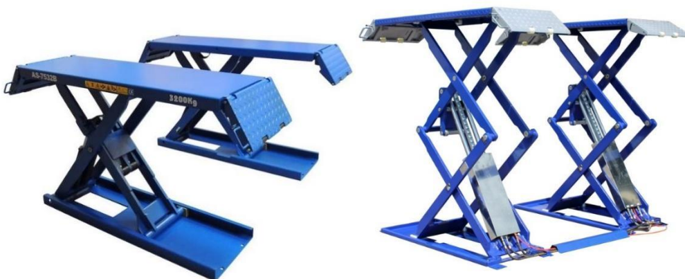
Slika 2. a) jednostruki škarasti podizni mehanizam s manjim dosegom podizanja; b) dvostruki škarasti podizni mehanizam s velikim dosegom podizanja
