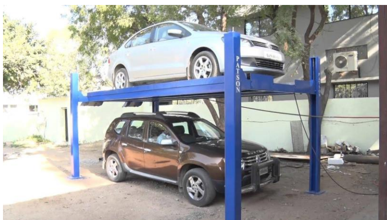
Slika 15. Dupla podizna platforma na pogon preko sajli
