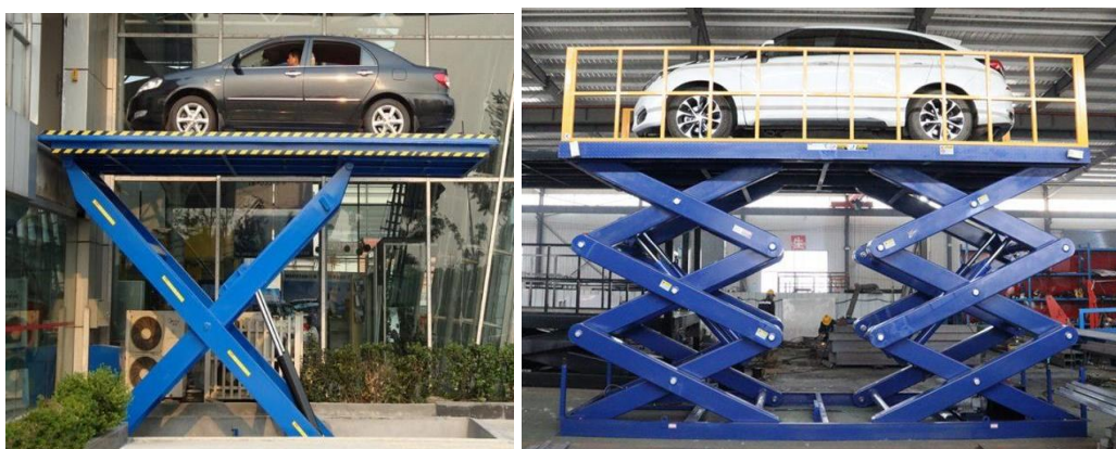
Slika 3. a) transportna podizna platforma s jednostrukim škarastim mehanizmom u ukopanoj izvedbi; b) škarasta podizna platforma s višestrukim škarastim mehanizmom
