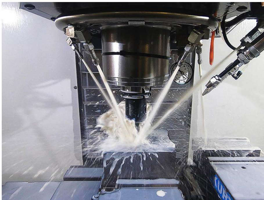
Slika 9. Hlađenje poplavljanjem s višestrukim mlaznicama [13]
