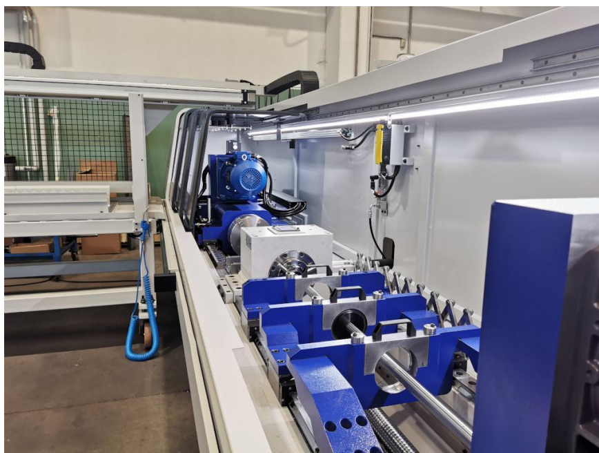
Slika 24. Stroj za duboko bušenje [27]
