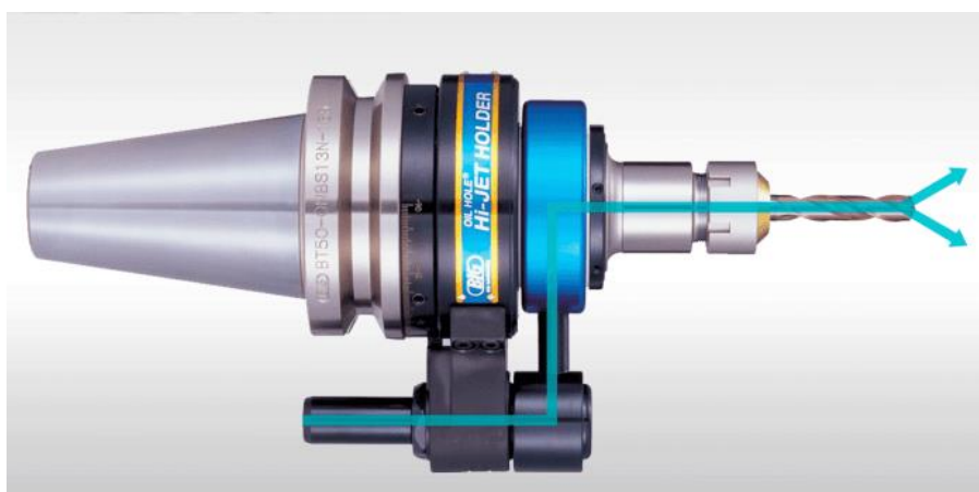
Slika 31. Dovod SHIP-a kroz Hi-Jet držač [31]
