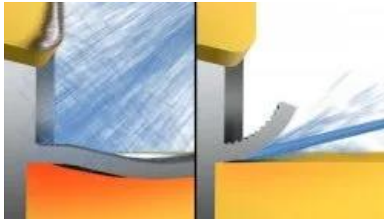
Slika 30. Usporedba klasičnog i preciznog dovođenja SHIP-a na prednju površinu alata [30]
