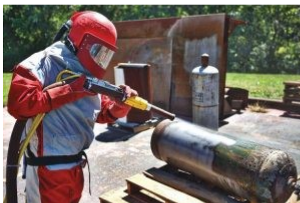
Slika 16. Čišćenje suhim mlazom abraziva [35]
