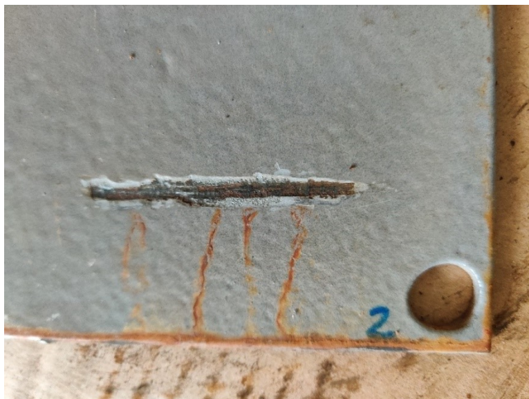
Slika 29. Očišćeno mjesto zareza na uzorku 2
