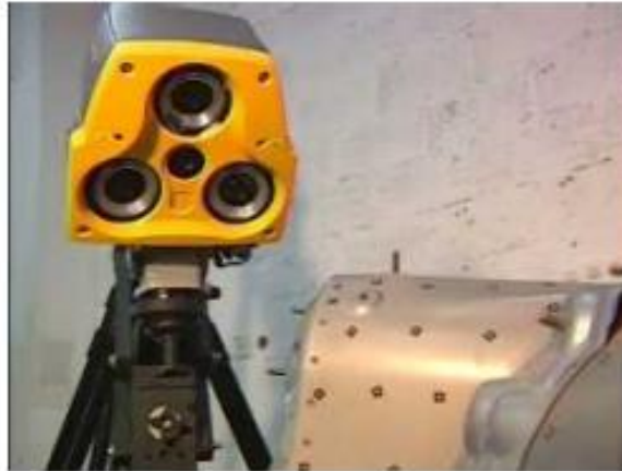
Slika 2. Vizijski sustav za inspekciju kontrole kvalitete [1]
