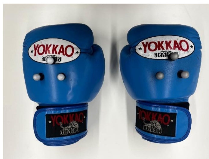
Slika 10. Raspored markera na boksačkoj rukavici
