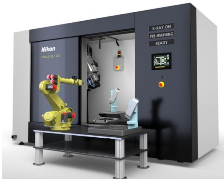
Slika 10 CT uređaj kojim upravlja robot [11]
