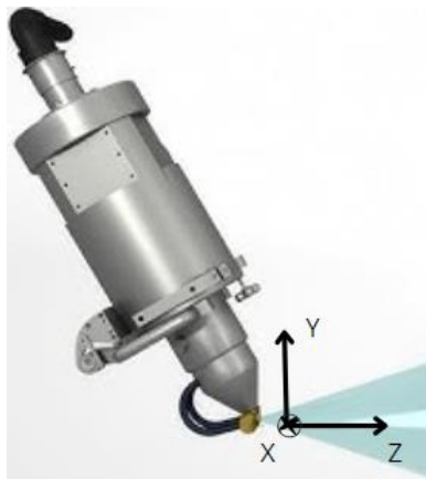
Slika 11 X, Y, Z ravnina CT skenera
