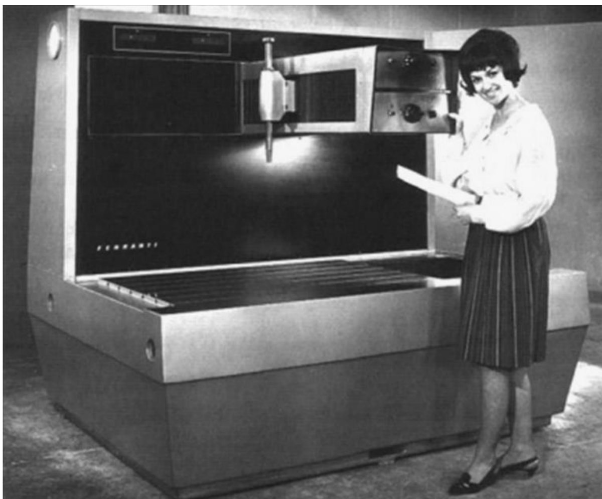
Slika 1. Trokoordinatni mjerni uređaj tvrtke Ferranti [1]
