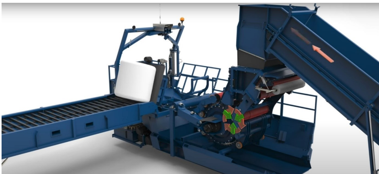
Slika 12. Prikaz prebacivanja bale na transportnu traku [11]
