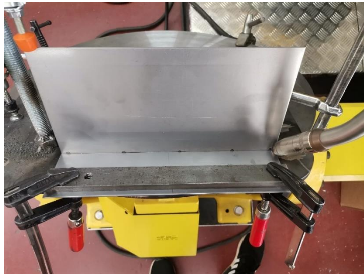
Slika 58. Položaj pištolja za zavarivanje – lijeva tehnika rada
