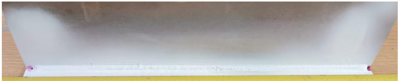
Slika 66. Pregled indikacija pukotina na uzorku 1
