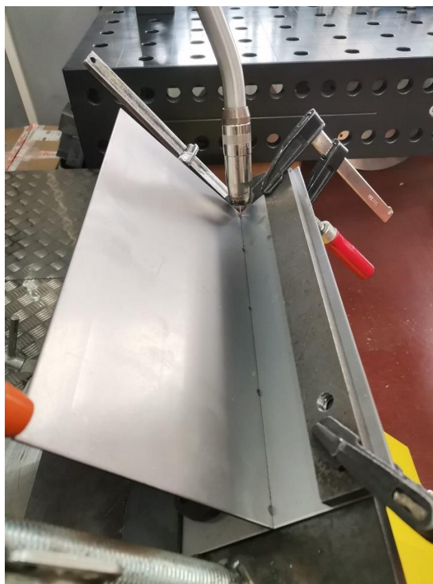
Slika 57. Uzorak u PA položaju zavarivanja
